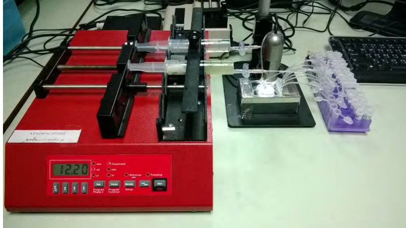
รูปที่ 8 แสดงการติดตั้งอุปกรณ์เข้ากับปั๊มอัตโนมัติเพื่อทดสอบการทำงาน
