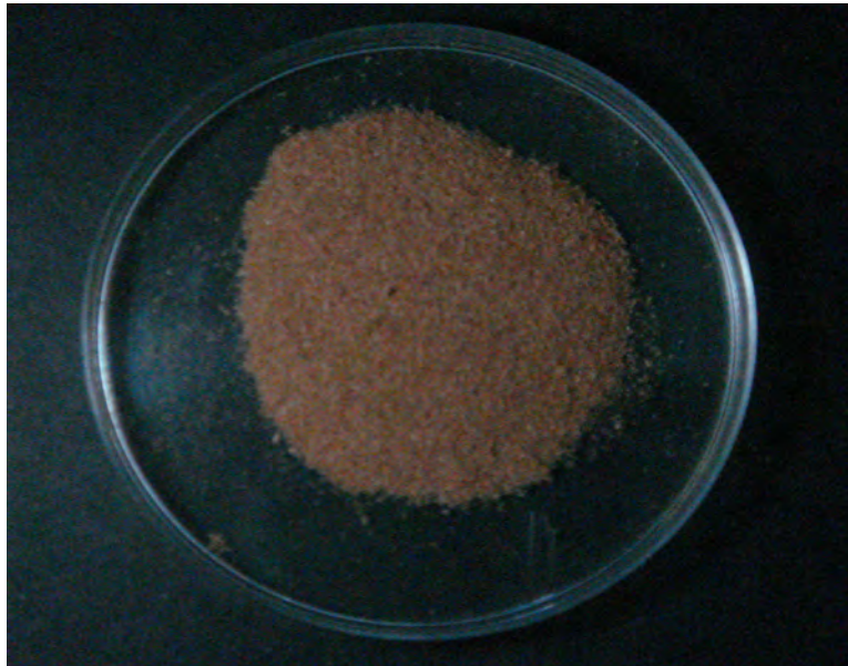
รูป จ-26 เส้นใยกบดแอสเบสต์ด้วย APTES ในน้ำกลั่น และทำปฏิกิริยากับกลูตาราลดีไฮด์ความเข้มข้นร้อยละ 0.2
