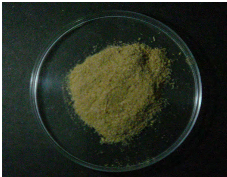
รูป จ-25 เส้นใยกกอบดแอคติเวตด้วย APTES ในน้ำกลั่น
