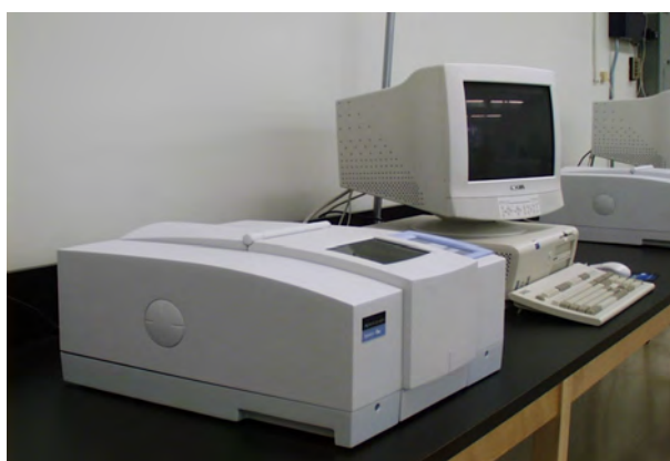
รูปที่ 3.4 เครื่องฟูเรียร์ทรานส์ฟอร์มอินฟราเรดสเปกโทรมิเตอร์ (FTIR) ยี่ห้อ Perkin Elmer รุ่น Spectrum One
