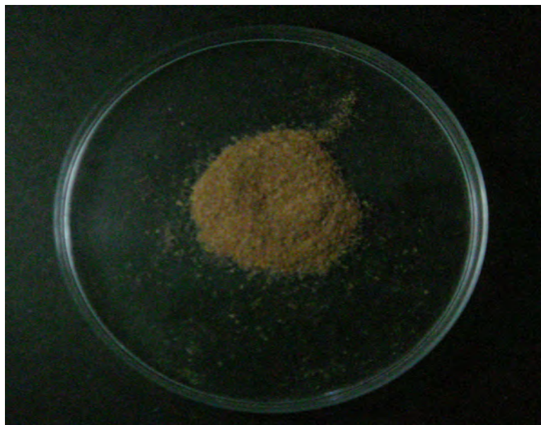
รูป จ-27 ไลเพสตรึงรูปที่ใช้วิธีเชื่อมขวางด้วยกลูตาราลดีไฮด์ความเข้มข้นร้อยละ 0.2
