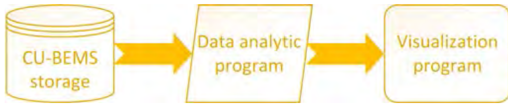
รูปที่ 2.7: แผนภาพการทำงานของโปรแกรมวิเคราะห์ข้อมูลสำหรับระบบจัดการพลังงานไฟฟ้าภายในอาคารบนพื้นฐานมาตรฐาน IEEE1888
