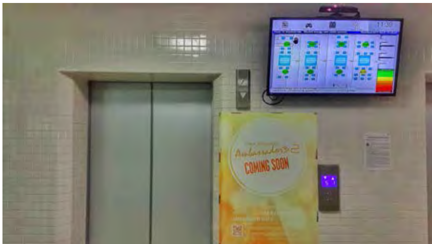
รูปที่ 5.37: การนำเสนอค่าความสูญเสียเปล่าของพลังงานไฟฟ้าที่ใช้กับระบบเครื่องปรับอากาศผ่านทางโปรแกรมสร้างมโนภาพเชิงโต้ตอบบริเวณหน้าลิฟท์ชั้น 13
