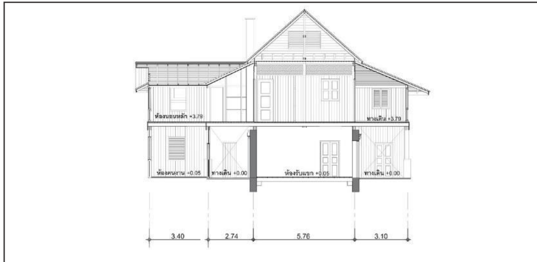
ภาพ 76 รูปตัดตามขวางแสดงโครงสร้างของเรือนพักผู้จัดการบริษัทอีสต์เอเชียติกในช่วงปี พ.ศ.2541-ปัจจุบัน
