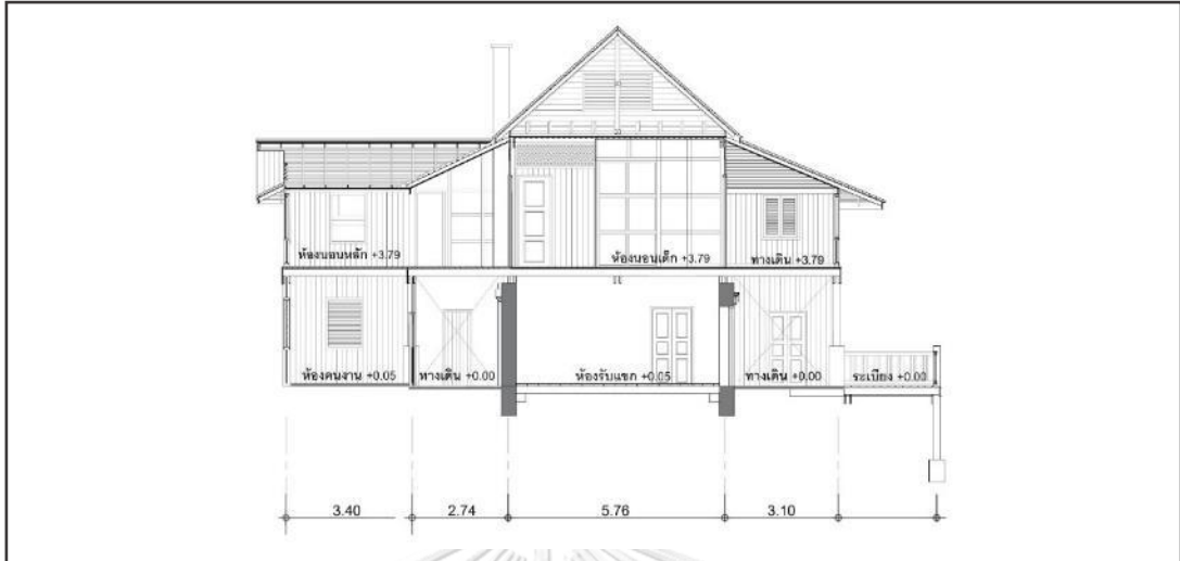
ภาพ 70 รูปตัดตามยาวแสดงโครงสร้างของเรือนพักผู้จัดการบริษัทอีสต์เอเชียติกในช่วงปี พ.ศ.2501-2540
