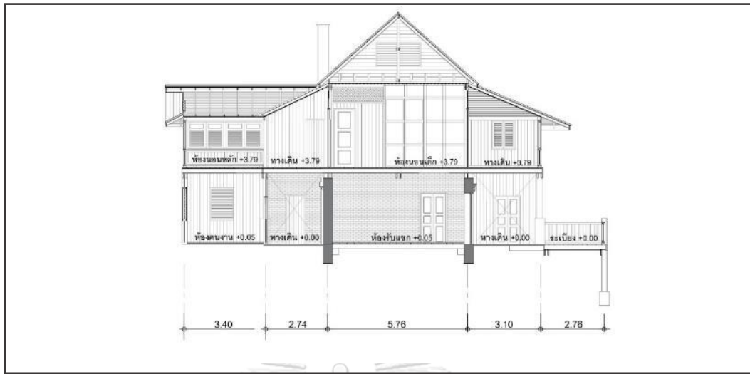
ภาพ 64 รูปตัดตามขวางแสดงโครงสร้างของเรือนพักผู้จัดการบริษัทอีสต์เอเชียติกในช่วงปี พ.ศ.2479-2500
