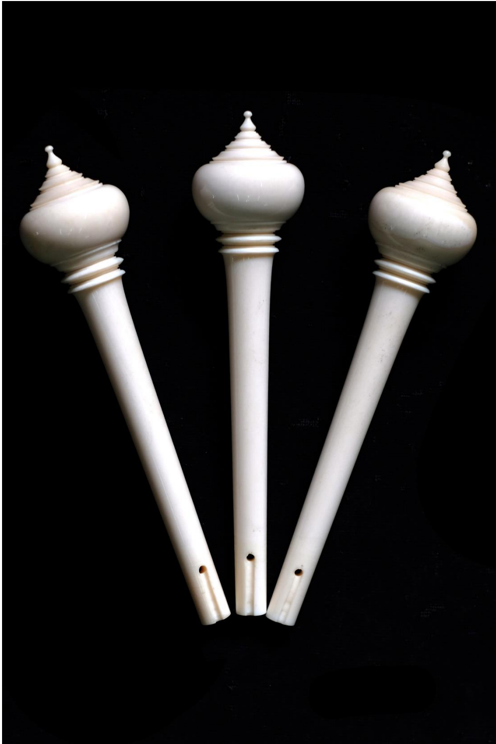
ภาพที่ 4.121 การเจาะรูและร่องลำเลียงสาย ที่มาภาพ: อนันท์สิทธิ์ การหนองใหญ่
