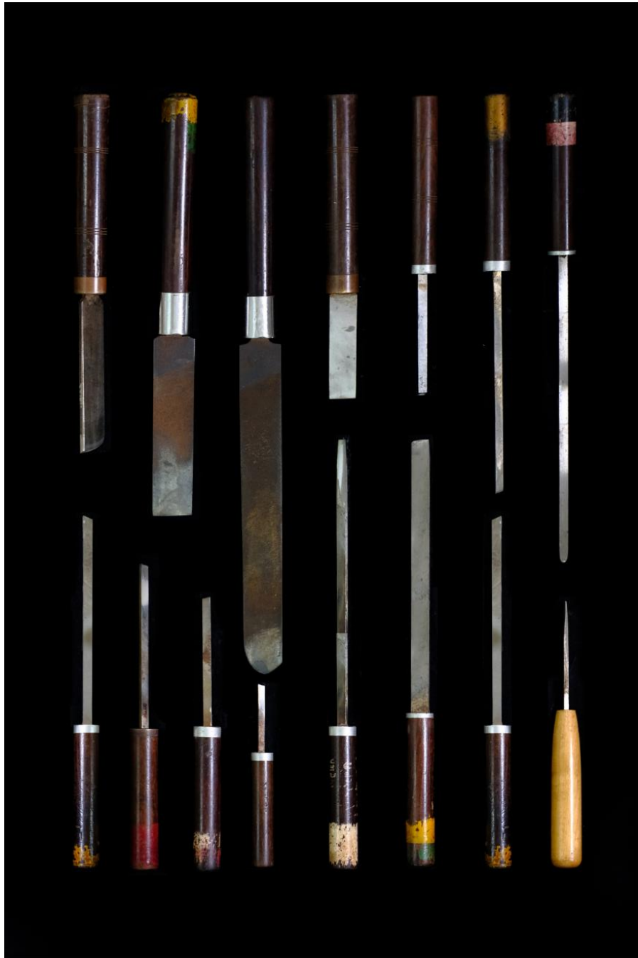
ภาพที่ 4.82 อุปกรณ์สิ่วสำหรับกลึง ที่มาภาพ: อนันต์สิทธิ์ การหนองใหญ่
