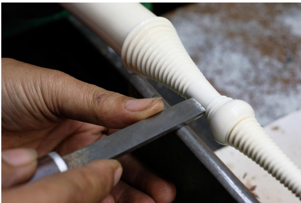
ภาพที่ 4.94 การใช้ปลายมีดกลึงเรียบ ที่มาภาพ: อนันต์สิทธิ์ การหนองใหญ่ CHULALONGKORN UNIVERSITY
