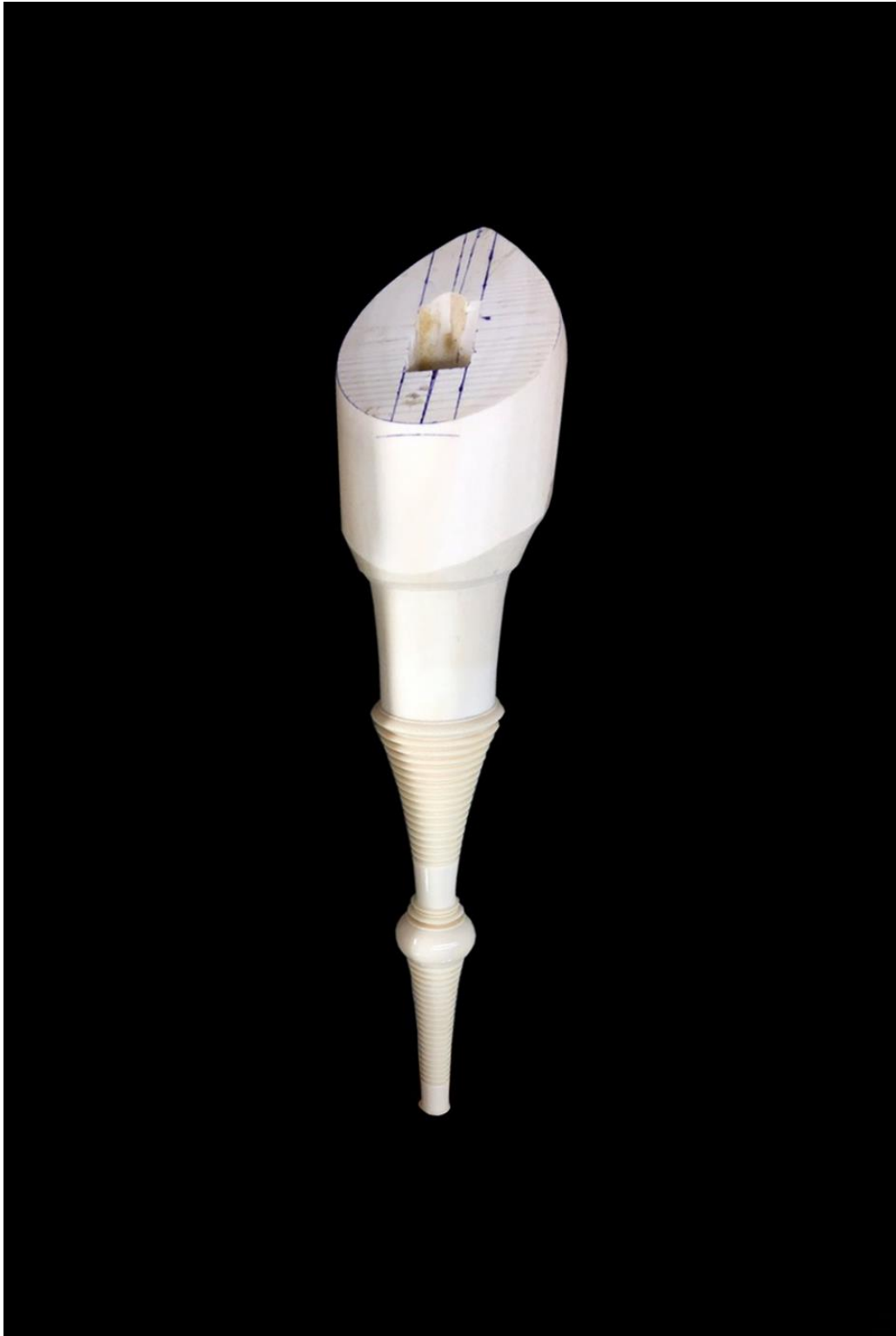
ภาพที่ 4.97 การกลึงเข้ารูปเท้าซอซอสามสาย ที่มาภาพ: อนันท์สิทธิ์ การหนองใหญ่
