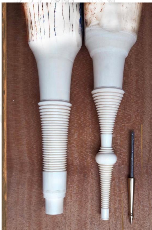
ภาพที่ 4.101 การกลึงเข้ารูปทวนล่าง เเท้ซอ และยอดทองเหลือง ที่มาภาพ: อนันท์สิทธิ์ การหนองใหญ่
