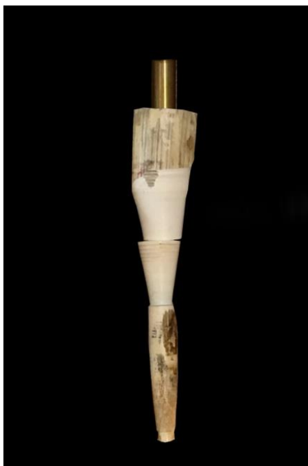
ภาพที่ 4.79 ลักษณะการประกอบของเท้า ที่มาภาพ: อนันต์สิทธิ์ การหนองใหญ่
