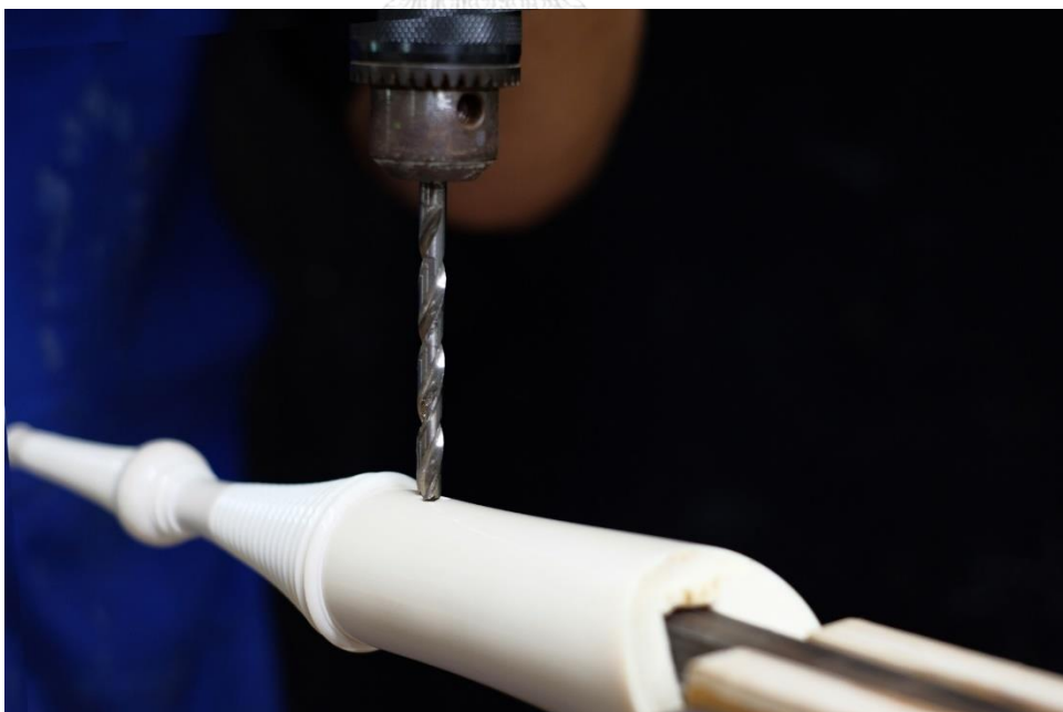
ภาพที่ 4.133 การใช้สว่านเจาะรูร้อยสายเท้าขอ ที่มาภาพ: อนันต์สิทธิ์ การหนองใหญ่
