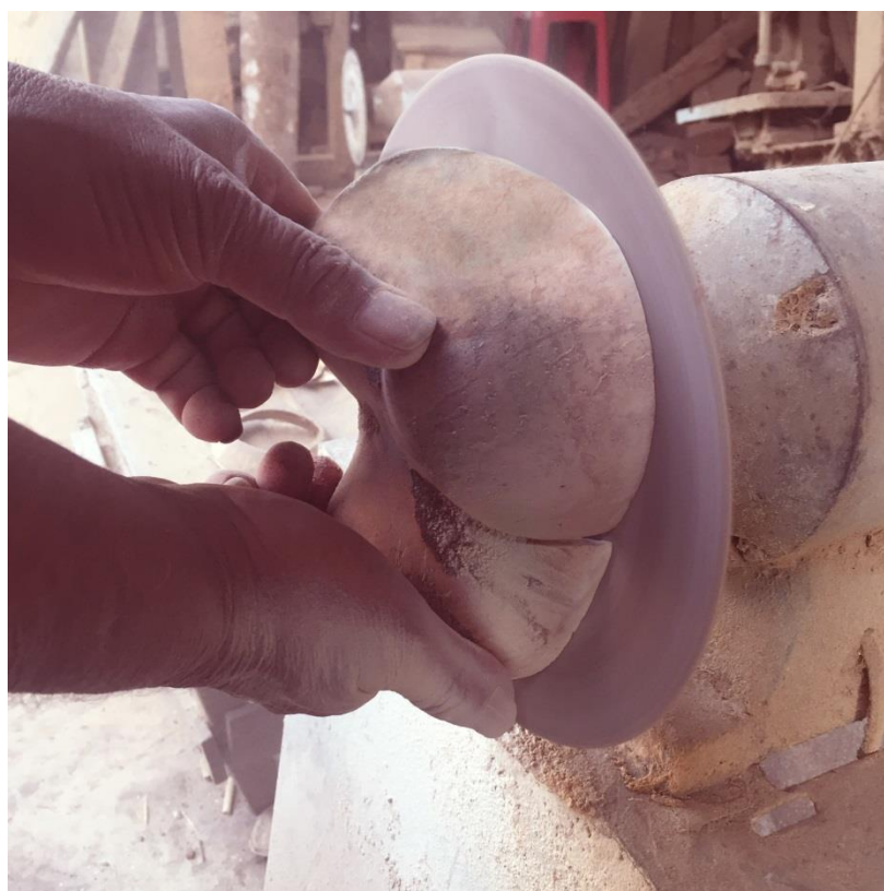
ภาพที่ 4.36 การปรับความสูงของกะลาในเข้ากับขนง ที่มาภาพ: ศักดิ์ชัย กาย
