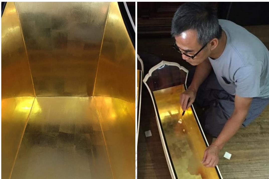
ภาพที่ 3.26 - 3.27 ขั้นตอนการปิดทองภายในรางระนาด
