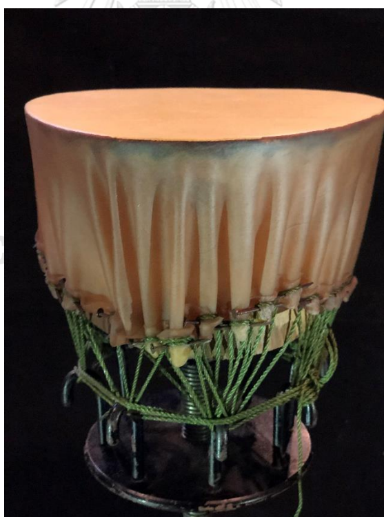
ภาพที่ 4.54 ลักษณะการคล้องเชือกกับตะขอที่ยึดบนแป้นเกลียวหมุน ที่มาภาพ: ศักดิ์ชัย กาย
