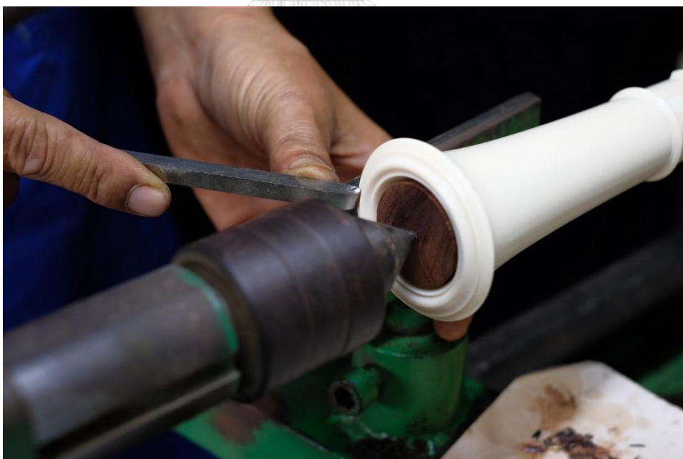
ภาพที่ 4.86 การกลึงลูกแก้วช่วงทวนบน ที่มาภาพ: อนันท์สิทธิ์ การหนองใหญ่
