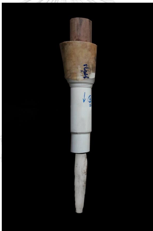
ภาพที่ 4.76 ลักษณะการกลึงล้างไล่ระดับเท้าขอ ที่มาภาพ: อนันต์สิทธิ์ การหนองใหญ่
