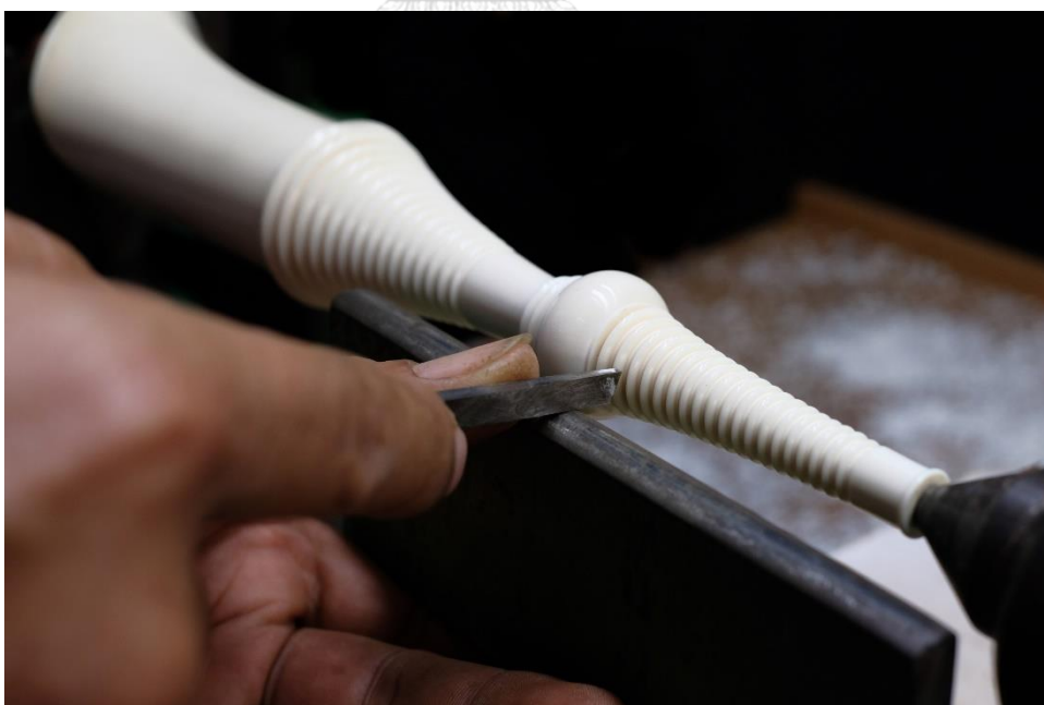
ภาพที่ 4.96 การใช้มีดกลึงเกลียวเจดีย์ ที่มาภาพ: อนันท์สิทธิ์ การหนองใหญ่
