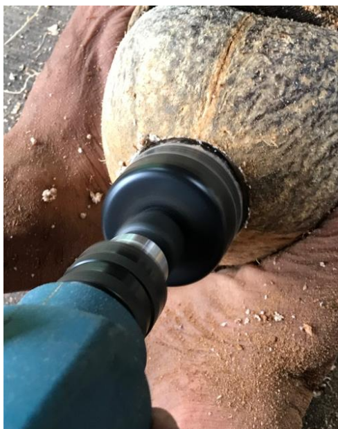
ภาพที่ 4.13 การใช้สว่านไฟฟ้าเจาะรูกะลามะพร้าว ที่มาภาพ: ศักดิ์ชัย กาย
