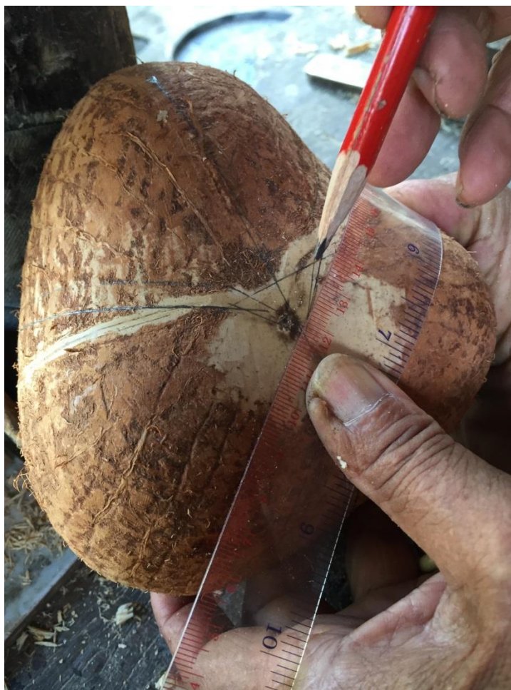
ภาพที่ 4.22 ลักษณะวาดรูปสามเหลี่ยมบนกะลามะพร้าวขอ
