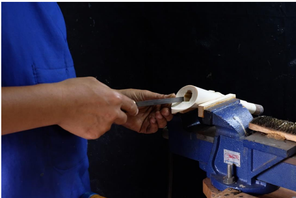
ภาพที่ 4.103 การปรับรูปเพื่อเสียบแกนยึดทวน ที่มาภาพ: อนันท์สิทธิ์ การหนองใหญ่
