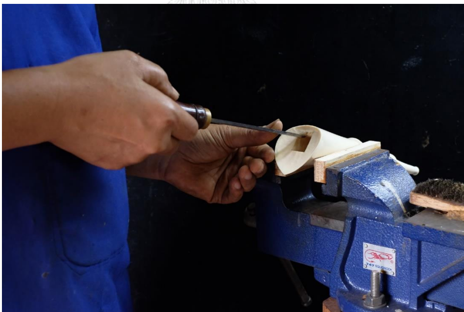
ภาพที่ 4.107 การใช้สิ่วคว้านรูเสียบแกนยึดทวน ที่มาภาพ: อนันต์สิทธิ์ การหนองใหญ่
