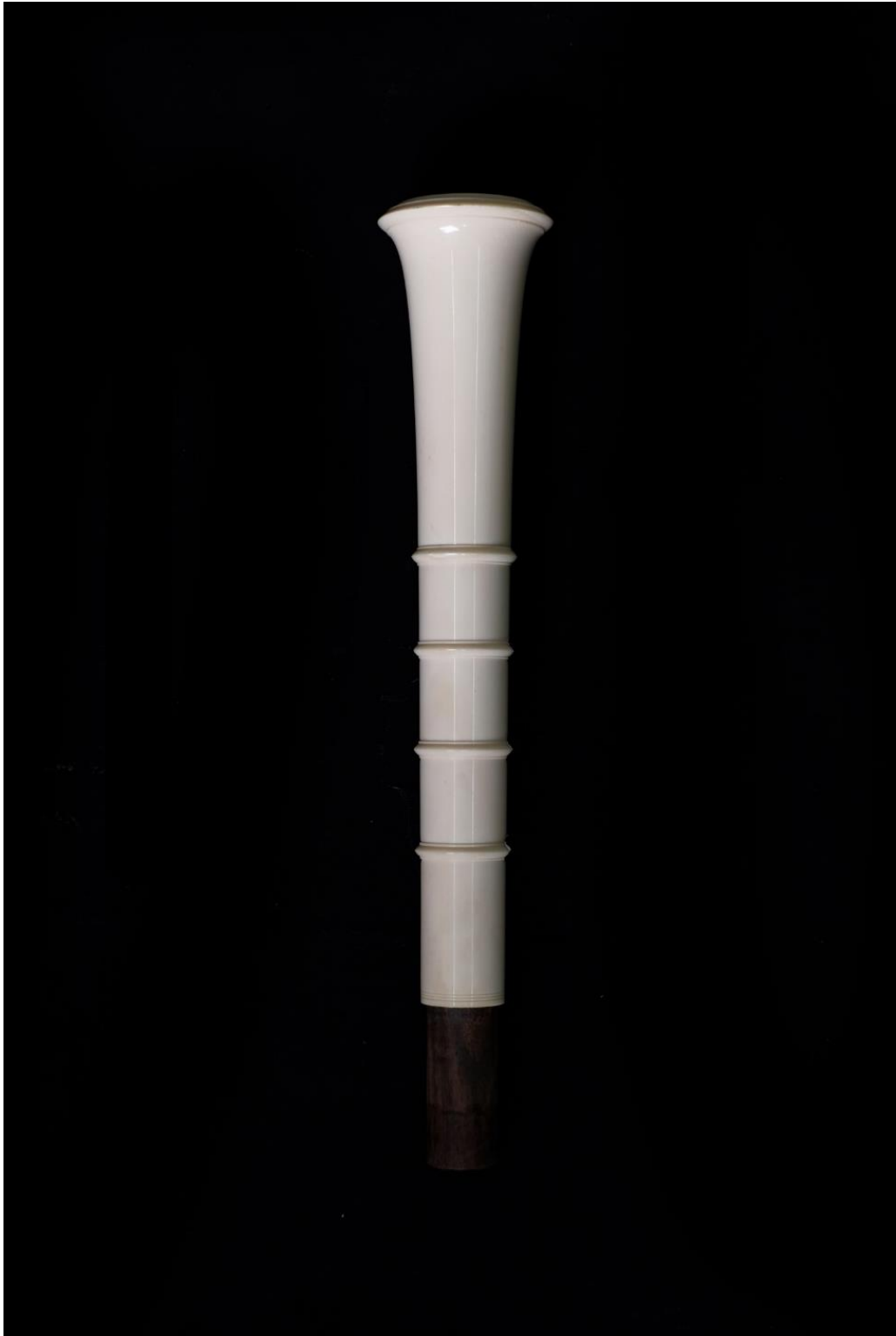
ภาพที่ 4.89 การกลึงเข้ารูปทวนบนซอสามสายในรูปแบบสมบุรณ์ ที่มาภาพ: อนันท์สิทธิ์ การหนองใหญ่
