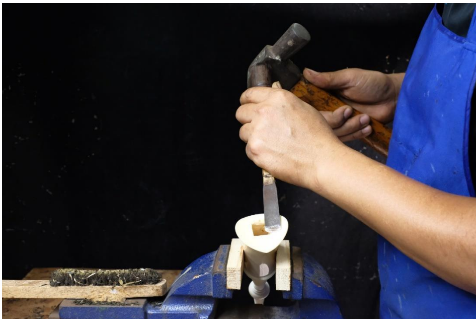
ภาพที่ 4.106 การใช้ค้อนตอกกับสิ่วคว้านปากข้างล่าง ที่มาภาพ: อนันต์สิทธิ์ การหนองใหญ่
