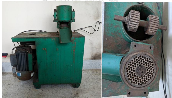
รูปที่ 3.5 เครื่องอัดเม็ดขนาดมอเตอร์ 3 kW
