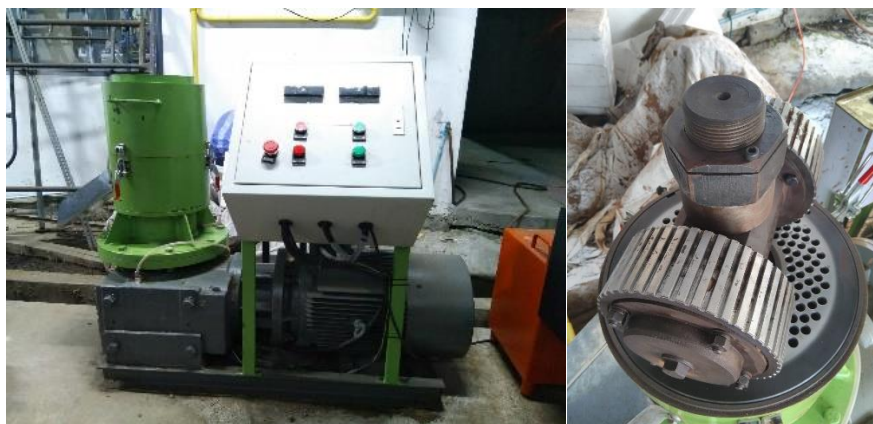
รูปที่ 3.6 เครื่องอัดเม็ดขนาดมอเตอร์ 22 kW
