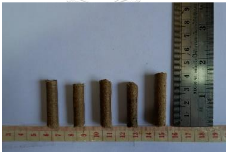
รูปที่ 4.3 ลักษณะเชื้อเพลิงอัดเม็ดจากทะเลลายปาล์มเปล่า
