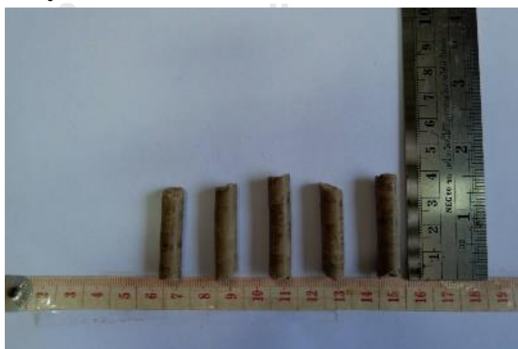
รูปที่ 4.4 ลักษณะเชื้อเพลิงอัดเม็ดจากทะเลลายปาล์มเปล่าผสมซีลี้อย่างพาราอัตราส่วน 1:6
