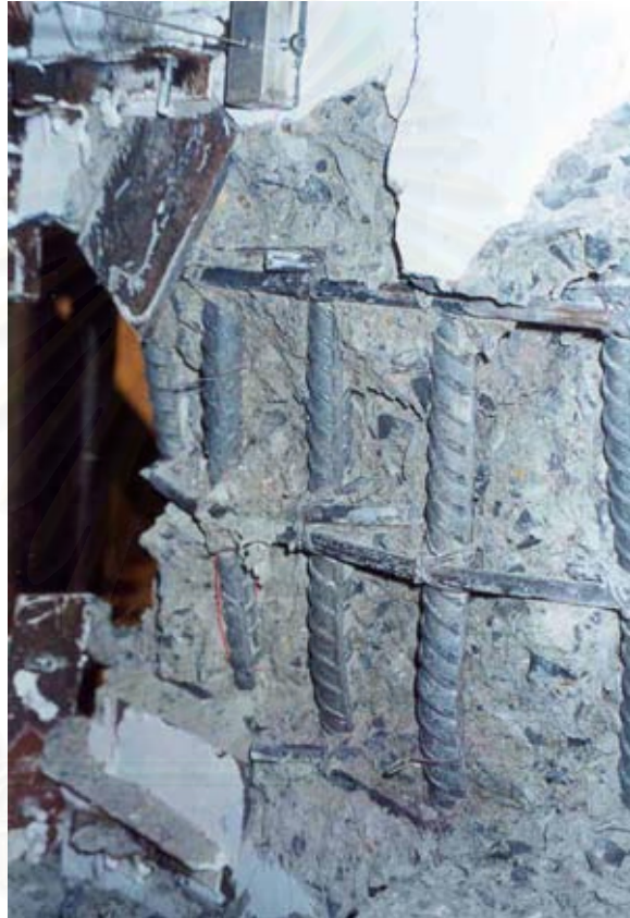
รูปที่ 4.17 แสดงภาพการชำรุดของของ 90 องศาในเหล็กยึดทางขวาง (crosstie) ชั้นที่ 2 ของตัวอย่าง CF135/120/0.37
