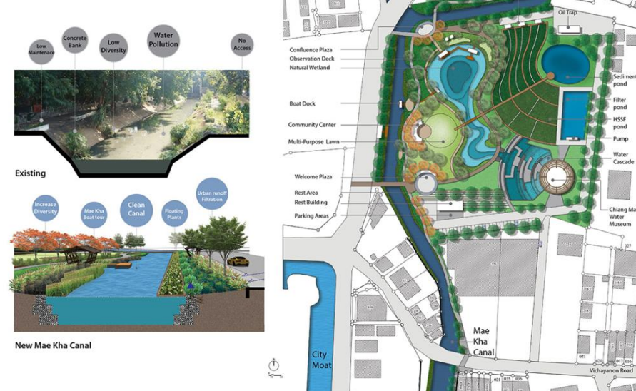
รูปที่ 2-14 แสดงการออกแบบสวนและพื้นที่บำบัดน้ำเสีย ที่มา: ASLA (2016b)
