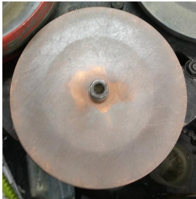
รูปที่ 4.9 การใส่ผงเพชรด้วยครีมลงบนจานทองแดงที่ผ่านการกรัดร่อง
