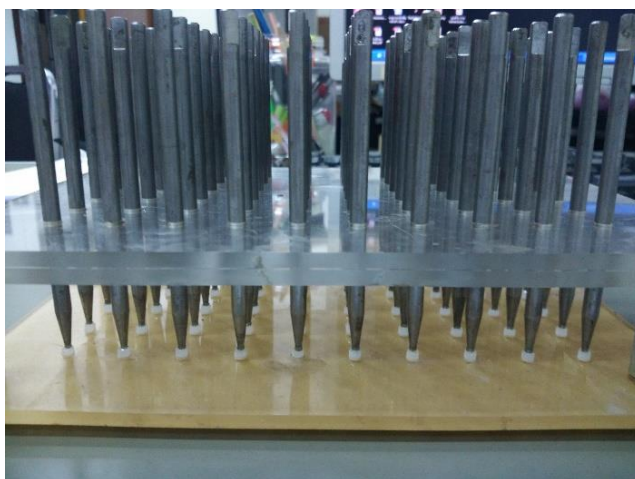
รูปที่ 4.3 การวางพลอยที่ปลายของทวนตีดพลอยบนอุปกรณ์ยึดจับ
