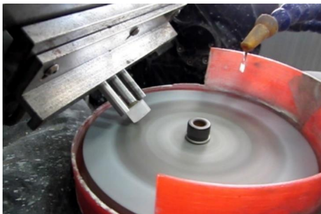
รูปที่ 5.2 การทดลองเจียรไนพลอยแล้วปรับค่าพารามิเตอร์ต่างๆ
