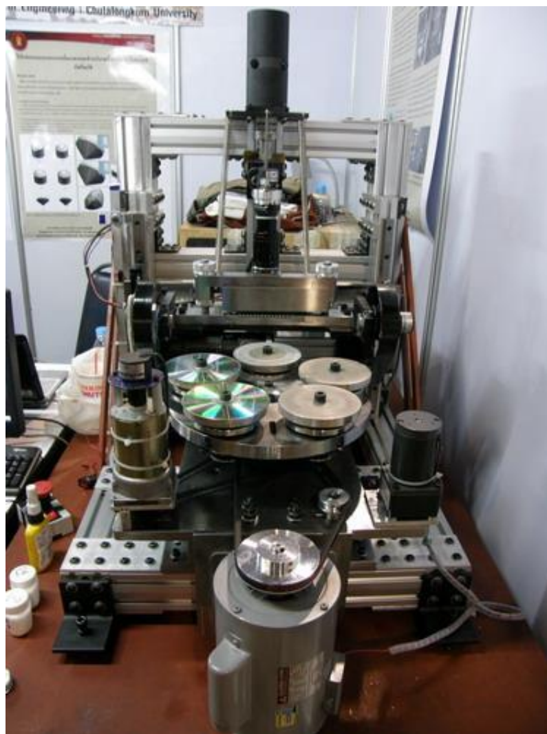
รูปที่ 2.3 เครื่องเจียรไนพลอยจิวาแบบอัตโนมัติรุ่นที่ 2
