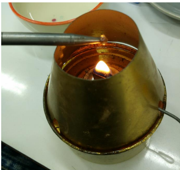
รูปที่ 4.14 การถอดพลอยออกจากทวนติดพลอยด้วยการอุ่นไฟ
