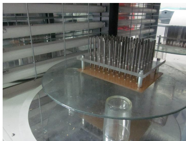
รูปที่ 4.4 การทำให้กาวแข็งตัวด้วยตู้อบรังสีอัลตราไวโอเลต
