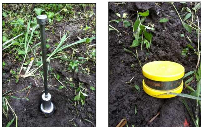
รูปที่ 3-7 อุปกรณ์ในการเก็บตัวอย่างดิน (Sampling core)
