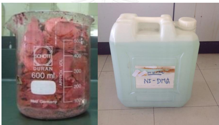
รูปที่ 2.1 ของเสียนิกเกิลจากการทดลองการหาปริมาณนิกเกิลในลวดนิกโครมด้วยวิธีวิเคราะห์โดยน้ำหนัก
