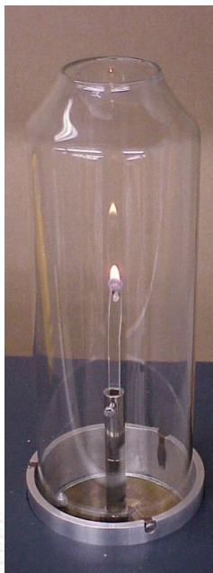
รูปที่ 3.3 การติดตั้งชิ้นทดสอบในเครื่องทดสอบความสามารถในการลุกติดไฟ
