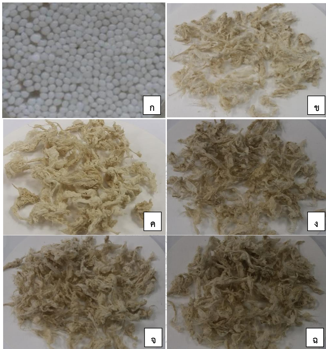
รูปที่ 4.1 แสดงลักษณะทางกายภาพของตัวดูดซับ (ก) ตัวดูดซับไคโตซาน (ข) ตัวดูดซับคอมพอสิตไคโตซาน-แรดดิน ที่สัดส่วนไคโตซานต่อแรดดิน เท่ากับ 1:0.5 (ค) ตัวดูดซับคอมพอสิตไคโตซาน-แรดดิน ที่สัดส่วนไคโตซานต่อแรดดิน เท่ากับ 1:1 (ง) ตัวดูดซับคอมพอสิตไคโตซาน-แรดดิน ที่สัดส่วนไคโตซานต่อแรดดิน เท่ากับ 1:2 (จ) ตัวดูดซับคอมพอสิตไคโตซาน-แรดดิน ที่สัดส่วนไคโตซานต่อแรดดิน เท่ากับ 1:3 (ฉ) ตัวดูดซับคอมพอสิตไคโตซาน-แรดดิน ที่สัดส่วนไคโตซานต่อแรดดิน เท่ากับ 1:5
