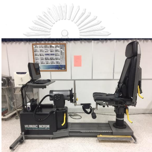
ภาพที่ 3.7 แสดงเครื่องมือทดสอบไอโซโคเนติก
