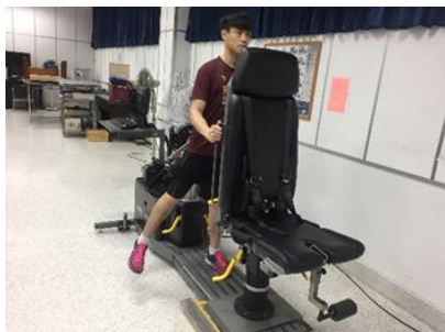
ภาพที่ 3.8 แสดงท่าทางการทดสอบความแข็งแรง ของกล้ามเนื้อกลุ่มกางและหุบสะโพก
