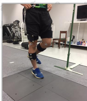
ภาพที่ 3.4 แสดงตำแหน่งการติด Reflective markers
