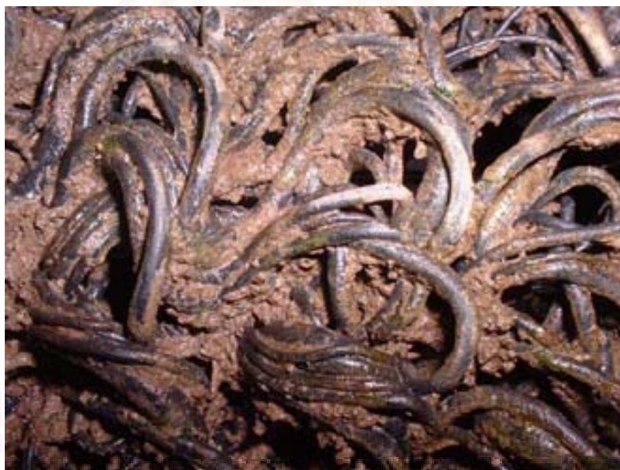
ภาพที่ 4-3 ภาพระยะใกล้แสดงพื้นผิวของตัวกรองชีวภาพที่ผ่านการแช่ในบ่อเลี้ยงปลามาแล้วเป็นเวลา 1 เดือน ซึ่งมีตะกอนและเมือกจุลินทรีย์เกาะอยู่
