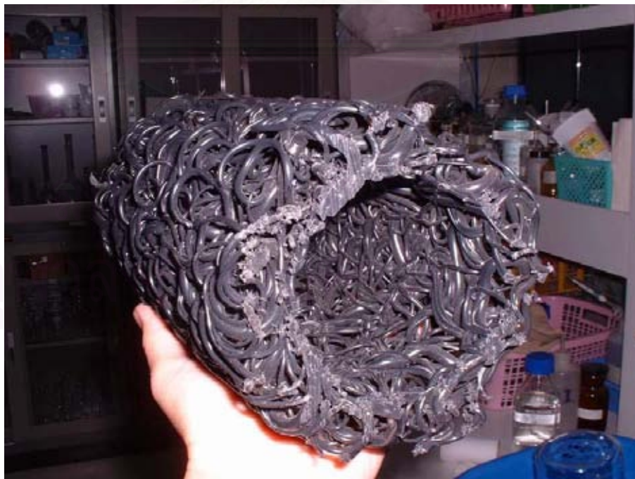
ภาพที่ 3-1 ตัวกรองชีวภาพทำจากพลาสติกชนิดโพลีโพรไพลีน (Hyper Drain)
