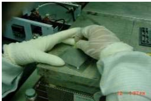
รูปที่ ข_3 การทา Wax บน pallet
