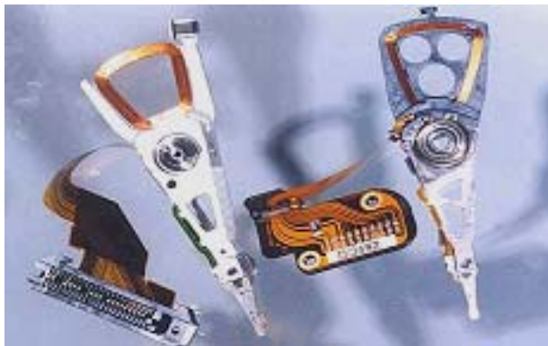
รูปที่ 1.3 ชุดหัวอ่าน-เขียนสำเร็จ (Head Stack Assembly)
