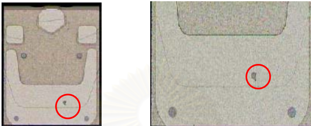
รูปที่ 4.12 ตรวจสอบปรกเนื่องจากการตกค้างของน้ำยาบนด้าน ABS
