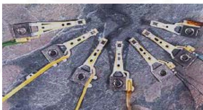
รูปที่ 1.2 ผลิตภัณฑ์หัวอ่าน-เขียนสำเร็จ (Head Gimbal Assembly)
