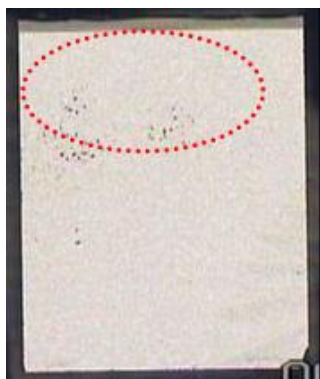
รูปที่ 4.20 คราบสกปรกเนื่องจากฝุ่นละอองบนด้าน Backside
