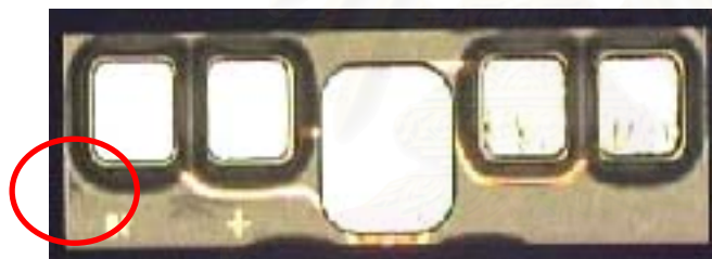
รูปที่ 4.15 คราบสกปรกเนื่องจากการตกค้างของน้ำยาบนด้าน DEPO
