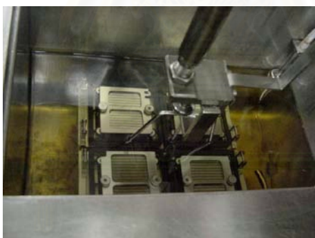
รูปที่ 6.8 ลักษณะการ Debond ด้วยน้ำยา NMP
