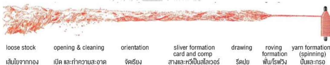
ภาพที่ 18 ภาพกระบวนการปั่นเส้นใยเป็นเส้นด้าย
