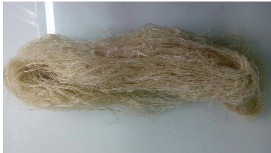
ภาพที่ 23 ภาพเส้นใยดาหลาดากแห้งรอตีเกลียว
