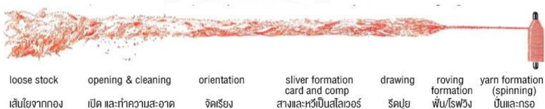
ภาพที่ 40 ภาพการตีเกลียวด้วยเครื่อง Pilot Spinning machine
