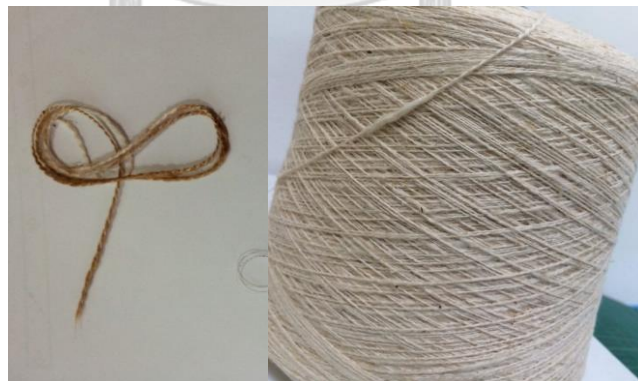
ภาพที่ 25 ภาพเส้นด้ายดาหลาหลังจากตีเกลียวฝ้าย 85 % ดาหลา 15 %
