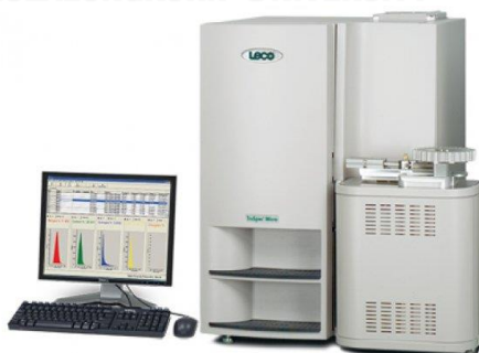
รูปที่ 3.7 เครื่องวิเคราะห์ธาตุคาร์บอน ไฮโดรเจน และไนโตรเจน
