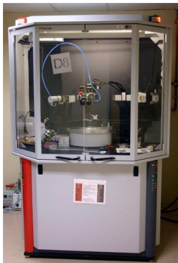
รูปที่ 3.12 เครื่องเอกซเรย์ดิฟแฟรคโทมิเตอร์
