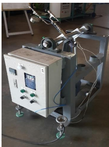
รูปที่ 3.2 ชุดทดลองที่ประกอบด้วยเครื่องปฏิกรณ์ขนาดเล็ก อุปกรณ์ควบคุมอุณหภูมิและอุปกรณ์ควบคุมการแกว่งเครื่องปฏิกรณ์
