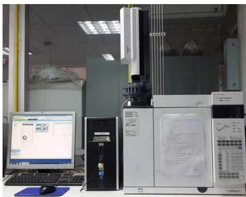
รูปที่ 3.10 เครื่องแก๊สโครมาโทกราฟพร้อมซอฟต์แวร์จำลองการกลั่น
