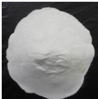
รูปที่ 3.6 ตัวเร่งปฏิกิริยาเอพซีซีใช้แล้ว
