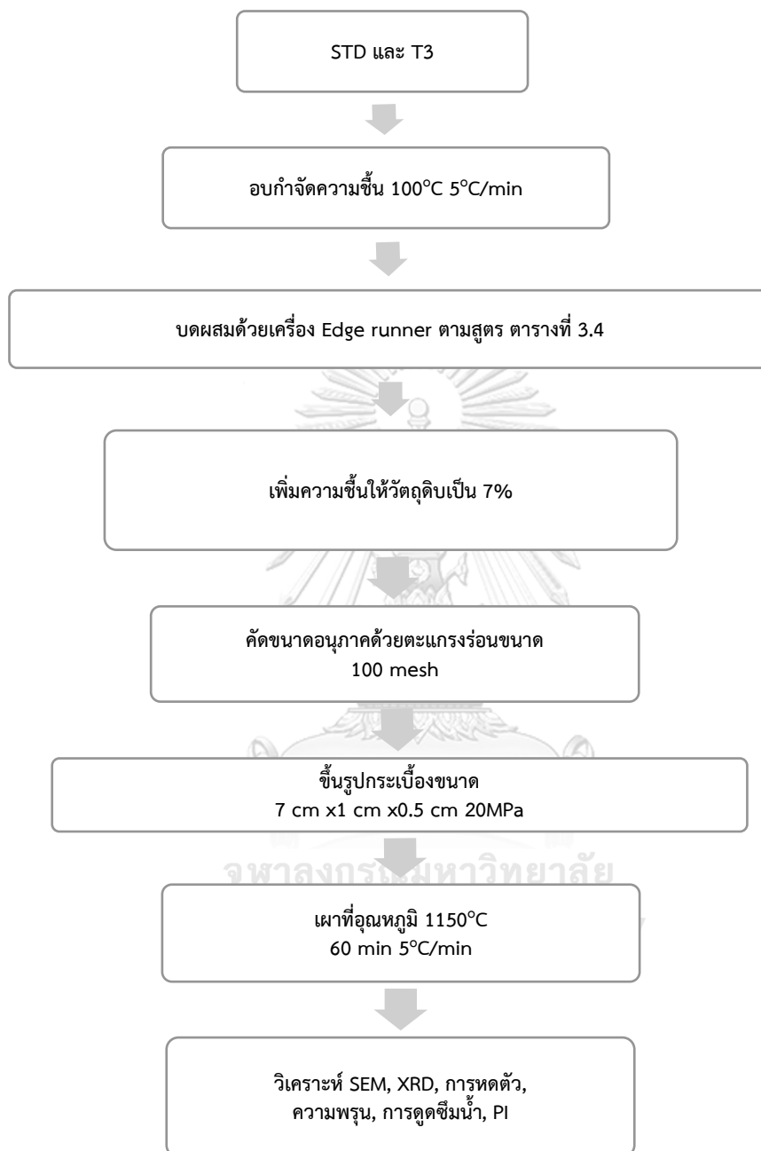
รูปที่ 3.3 แผนผังการเตรียมและทดสอบชิ้นงานกระเบื้องที่ใช้สมบัติของเก้าหนักลิทไนต์ในการต้านการแอ่นตัว
