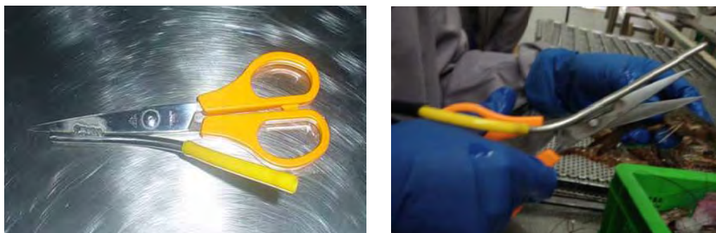
รูปที่ 6.1 กรรไกรดัดแปลงให้มีท่อสำหรับดูดมันกุ้ง
