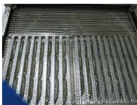
รูปที่ 6.8 การวางถาดต้มกุ้งชูชิบนสายพานเครื่องต้มกุ้งชูชิ
