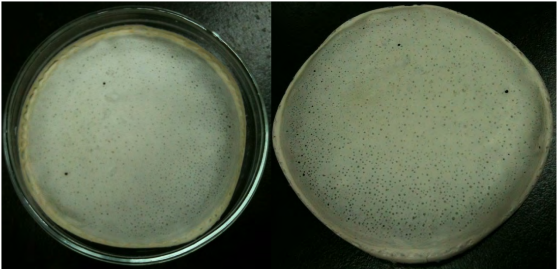
รูปที่ 4.32 ลักษณะของแผ่นฟิล์ม PHB ที่ผลิตจาก Bacillus sp. MSC-5 หลังผ่านขั้นตอนการทำ บริสุทธิ์แล้ว
