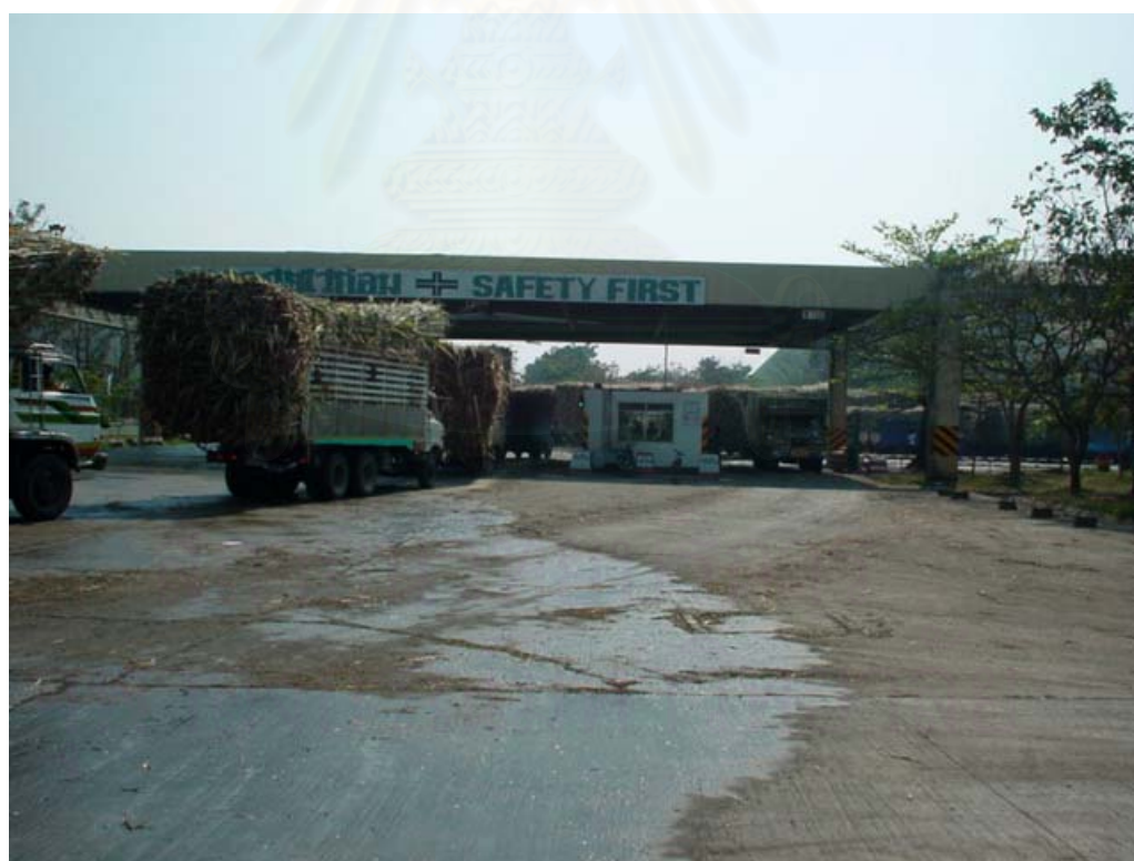
รูปที่ 3.19 การซังน้ำหนักรถหนัก (น้ำหนักรถบรรทุกพร้อมกับน้ำหนักรอ)
