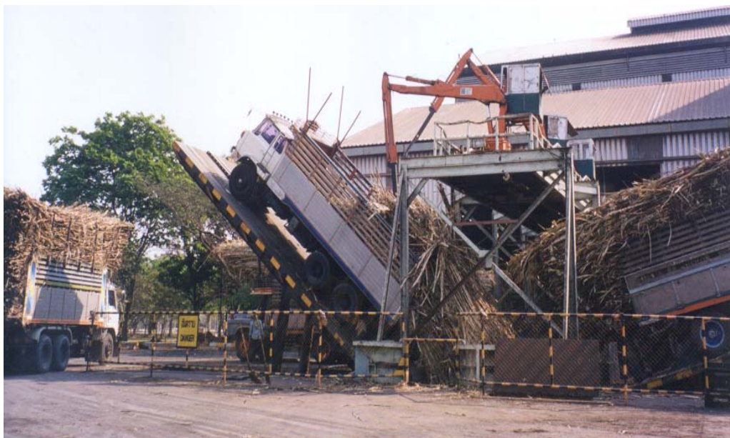
รูปที่ 3.22 ตะกาวกวาดอ้อยจากรถบรรทุกลงสายพานลำเลียงเข้าสู่ลูกลีบชุดที่ 1
