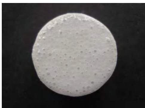
รูปที่ 4.2 (ต่อ) ลักษณะพื้นผิวของเคลือบแก้วบอโรซิลิเกต (a-i) และแก้วบอโรซิลิเกตผสมเซอร์โคเนีย ปริมาณร้อยละ 5 (j-r) บนผิวซิลิกอนไนไตรด์ ณ อุณหภูมิต่างๆ
