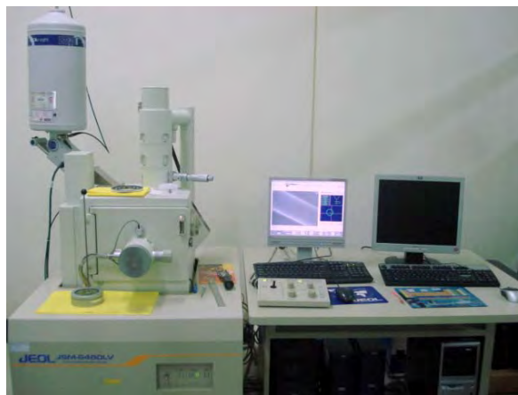
รูปที่ 3.11 กล้องจุลทรรศน์อิเล็กตรอนแบบส่องกราด (Scanning electron microscope, SEM)
