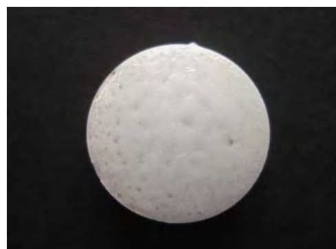
รูปที่ 4.2 (ต่อ) ลักษณะพื้นผิวของเคลือบแก้วบอโรซิลิเกต (a-i) และแก้วบอโรซิลิเกตผสมเซอร์โคเนีย ปริมาณร้อยละ 5 (j-r) บนผิวซิลิกอนไนไตรด์ ณ อุณหภูมิต่างๆ
