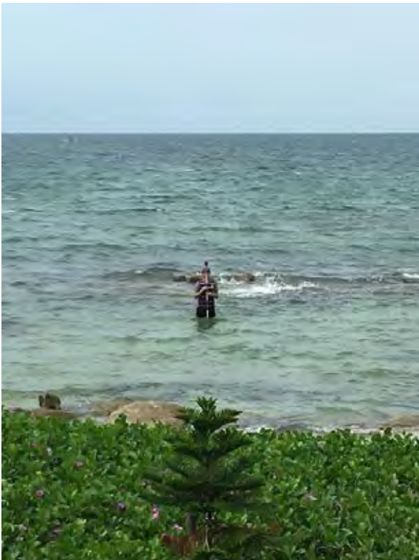
รูปที่ 3.9 การวัดระดับชายหาด (Beach profiling) ในแนวตั้งฉากกับชายหาดในช่วงน้ำลงต่ำสุด
