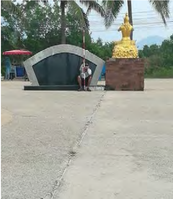
รูปที่ 3.8 การวัดระดับชายหาดโดยเริ่มวัดจากตำแหน่งอ้างอิงเดียวกัน
