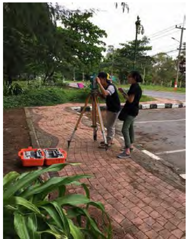
รูปที่ 3.9 การวัดระดับชายหาด (Beach profiling) ในแนวตั้งฉากกับชายหาดในช่วงน้ำลงต่ำสุด
