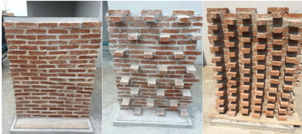
ภาพที่ 3.4 ผนังอิฐที่มีสัดส่วนการยื่น 0%, 20% และ 45% ของการทดลองชุดที่ 1.2
