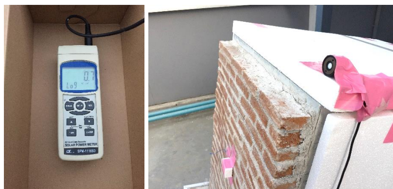
ภาพที่ 3.12 เครื่องมือวัดรังสีอาทิตย์ (Solar Power Radiation) และวิธีการติดตั้ง
