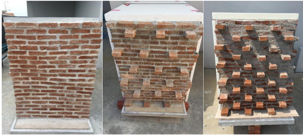
ภาพที่ 3.2 ผนังอิฐที่มีสัดส่วนการยื่น 0%, 15% และ 25% ของการทดลองชุดที่ 1.1
