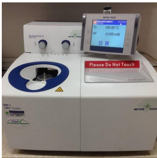
รูปที่ 3. 12 เครื่องดีฟเฟอเรนเชียลสแกนนิ่งแคลอริมิเตอร์ของ Mettler Toledo รุ่น DSC/1STER ®
