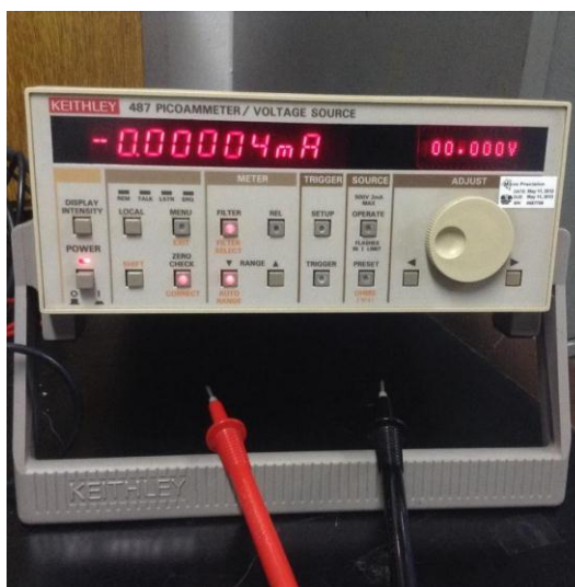
รูปที่ 3. 14 เครื่องวัดทดสอบไฟฟ้า (picoammeter/voltage source) ของ KEITHLEY รุ่น 487
