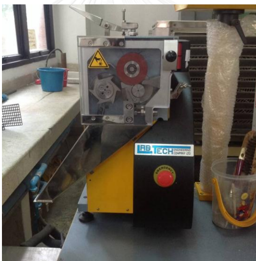
รูปที่ 3. 6 เครื่องตัดเม็ดพลาสติกของ Labtech Engineering รุ่น LZ-80/VS
