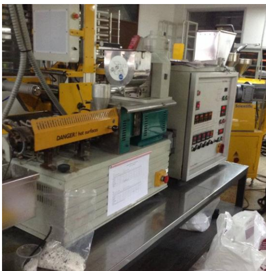
รูปที่ 3. 5 เครื่องอัดรีดสกรูคู่ของ Thermo Prism รุ่น DSR-28
