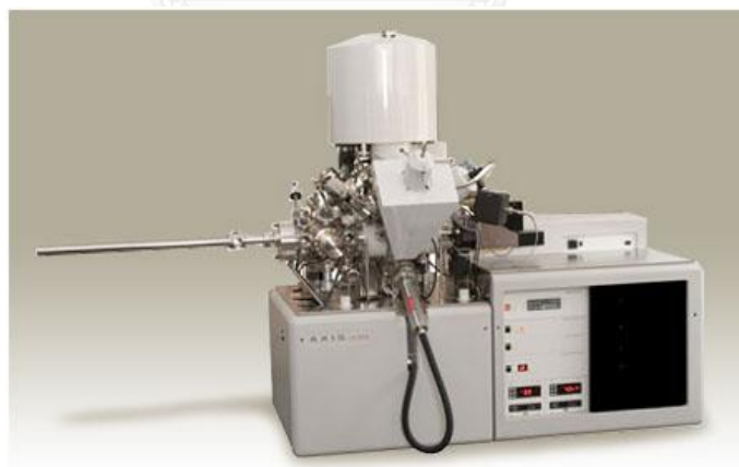
รูปที่ 3. 9 เครื่องสเปกโตรสโคปีของอนุภาคอิเล็กตรอนที่ถูกปลดปล่อยด้วยรังสีเอกซ์ ของ Kratos Analytical รุ่น AXIS Ultra DLD [27]
