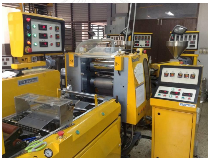
รูปที่ 3. 7 เครื่องรีดหล่อฟิล์มของ Labtech Engineering รุ่น LCR-300HDCO-EX
