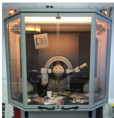
รูปที่ 3. 10 เครื่องวิเคราะห์การเลี้ยวเบนรังสีเอกซ์ในผลึก ของ Bruker AXS รุ่น D8 Advance
