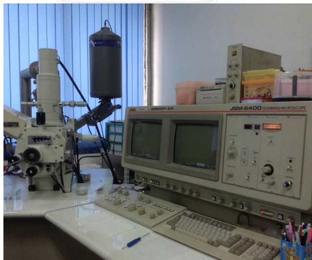
รูปที่ 3. 11 กล้องจุลทรรศน์อิเล็กตรอนแบบส่องกราด และอุปกรณ์วิเคราะห์ธาตุเชิงพลังงาน ของ JEOL รุ่น JSM-6400LV
