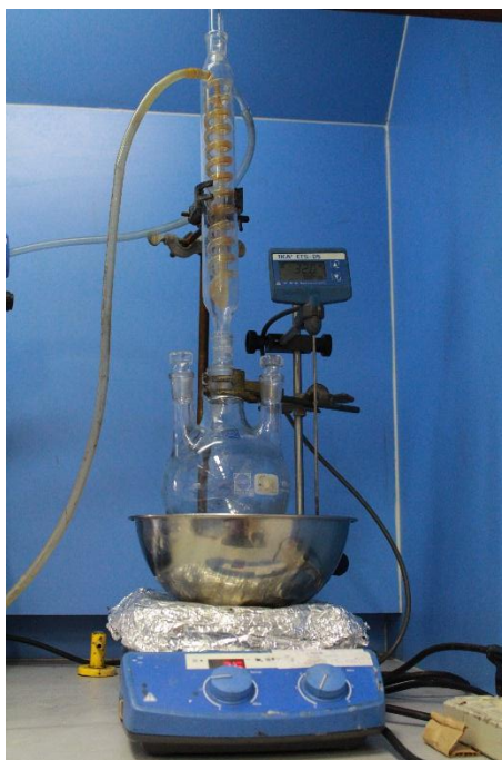
รูปที่ 3. 3 ชุดเตรียมแกรฟีนดัดแปรด้วยเฮกซะเดคซิลไตรเมทอกซีไซเลนและกรดแอลแอสคอร์บิก
