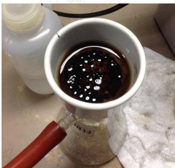
รูปที่ 3. 4 การกรองแกรฟีนดัดแปรด้วยชุดกรองบุชเนอร์แบบสุญญากาศ
