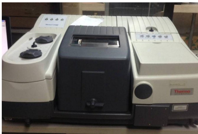
รูปที่ 3. 8 เครื่องฟูเรียร์ทรานส์ฟอร์มอินฟราเรดสเปกโทรสโกปี ของ Thermo Scientific รุ่น Nicolet 6700
