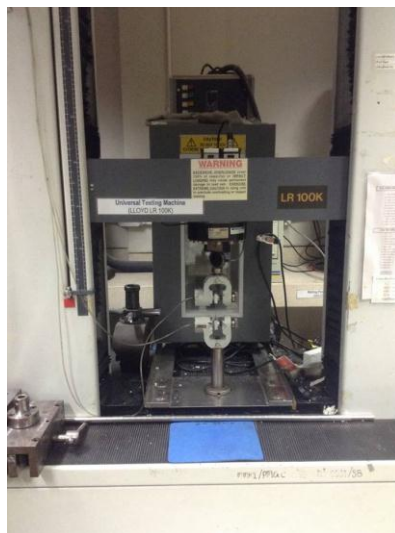
รูปที่ 3. 13 เครื่องทดสอบอเนกประสงค์ของ LLOYD รุ่น LR100K
