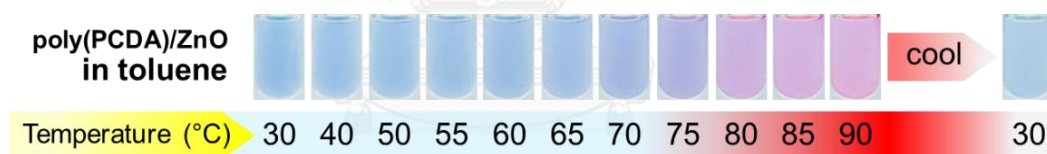
รูปที่ 4.66 ภาพถ่ายแสดงพฤติกรรมการเปลี่ยนสีต่ออุณหภูมิของสารแขวนลอยวัสดุเชิงประกอบในตัวกลางโทลูอีน
