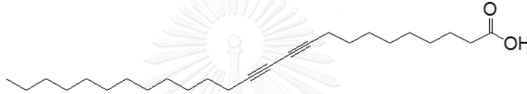
รูปที่ 4.1 โครงสร้างทางเคมีของมอนอเมอร์ 10,12-เพนตะโคเซไดโอนอิกแอซิด (PCDA)
