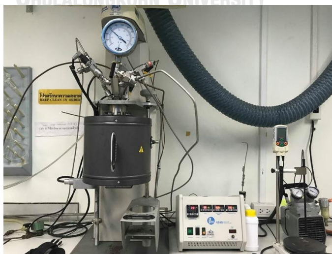
รูปที่ 3.1 เครื่องปฏิกรณ์ PARR Reactor Model 4848
