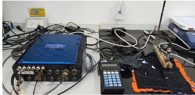
รูปที่ 3.11 เครื่องบันทึกข้อมูลเสียง และการสิ้นสะท้อน
