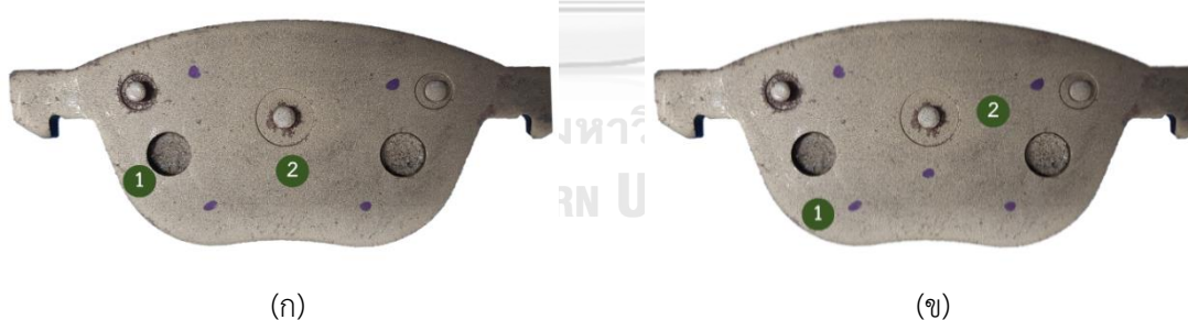
รูปที่ 3.10 ตำแหน่งการติดตั้งอุปกรณ์ตรวจวัดความเร่ง และการเคาะของ (ก) ความถี่ที่ 1 และ 4 และ (ข) ความถี่ที่ 2 และ 3
