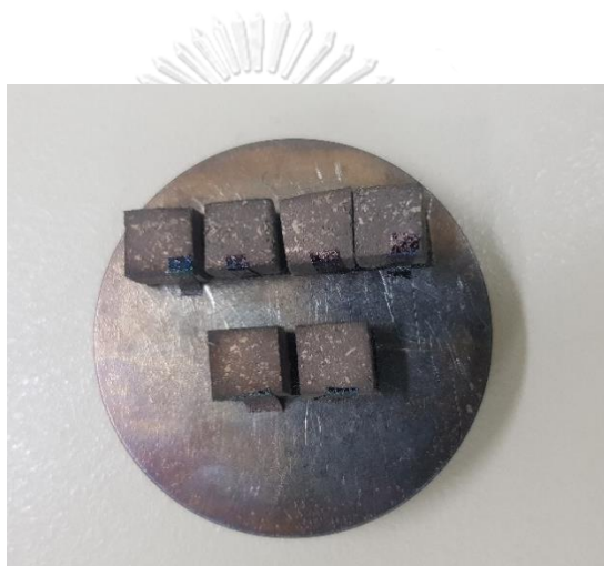
รูปที่ 3.19 ลักษณะผ้าเบรกที่เตรียมทดสอบด้วยกล้องจุลทรรศน์อิเล็กตรอนแบบส่องกราด
