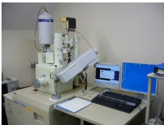
รูปที่ 3.18 กล้องจุลทรรศน์อิเล็กตรอนแบบส่องกราด JEOL รุ่น JSM-6480LV [45]
