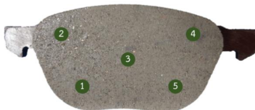
รูปที่ 3.15 ตำแหน่งการทดสอบความแข็งบนผ้าเบรก
