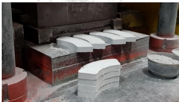
รูปที่ 3.3 ชิ้นงานผ้าเบรกหลังการอัดขึ้นรูปเย็น
