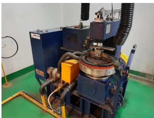
รูปที่ 3.17 เครื่องทดสอบสัมประสิทธิ์ความเสียดทาน
