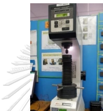
รูปที่ 3.14 เครื่องวัดความแข็งแบบร็อคเวลล์
