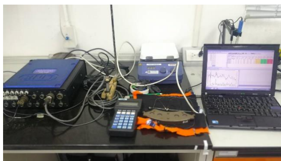
รูปที่ 3.18 การติดตั้งชุดบันทึกข้อมูลเสียงและความสั่นสะเทือนของยานยนต์
