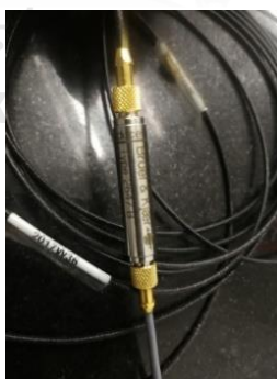
รูปที่ 3.8 ตัวแปลงสัญญาณ Type 2647B บริษัท Bruel & Kjaer
