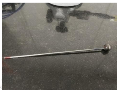
รูปที่ 3.9 ค้อนสำหรับเคาะชิ้นงานของ บริษัท คอมแพ็ค อินเทอร์เน็ตเนชั่นแนล(1994) จำกัด
