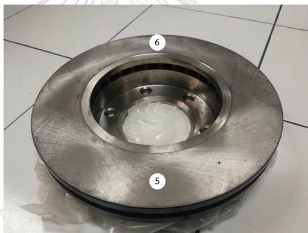
รูปที่ 3.22 ตำแหน่งในการติดตั้งตัววัดอัตราเร่งการสั่น และตำแหน่งในการเคาะของจานเบรก
