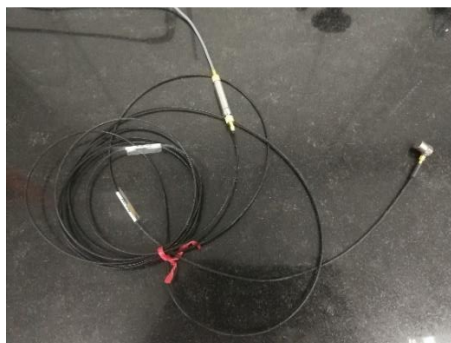
รูปที่ 3.6 เครื่องวัดอัตราเร่งการสั่นสะเทือน Type 4393 ของบริษัท Bruel & Kjaer
