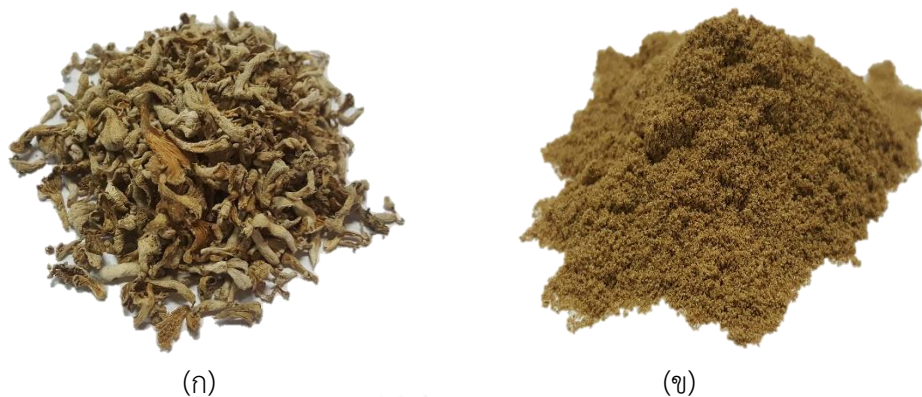
รูปที่ 4.1 ผงเห็ดแครงเหลือทิ้งจากกระบวนการแปรรูป (ก) ก่อนบด (ข) หลังบด
