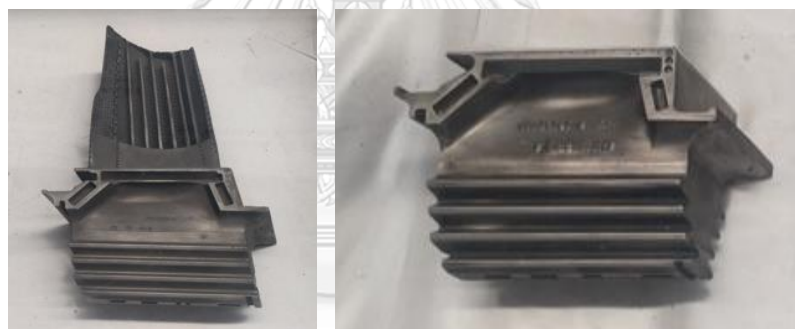
รูปที่ 2.5 ชิ้นส่วนใบพัดของเครื่องจักรกังหันก๊าซ (ที่มา: EGAT Diamond Services Co., Ltd) ตารางที่ 2.5 ส่วนผสมทางเคมีของโลหะผสมพิเศษ MGA 1400 (ร้อยละโดยน้ำหนัก) (1)
