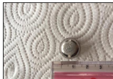
รูปที่ 3.2 ชิ้นงานก่อนและหลังหลอมด้วยเตาหลอมแบบอาร์กสุญญากาศ
