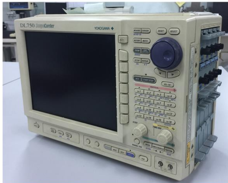
รูปที่ 3.7 ออสซิลโลสโคปยี่ห้อ Yokogawa รุ่น DL750
