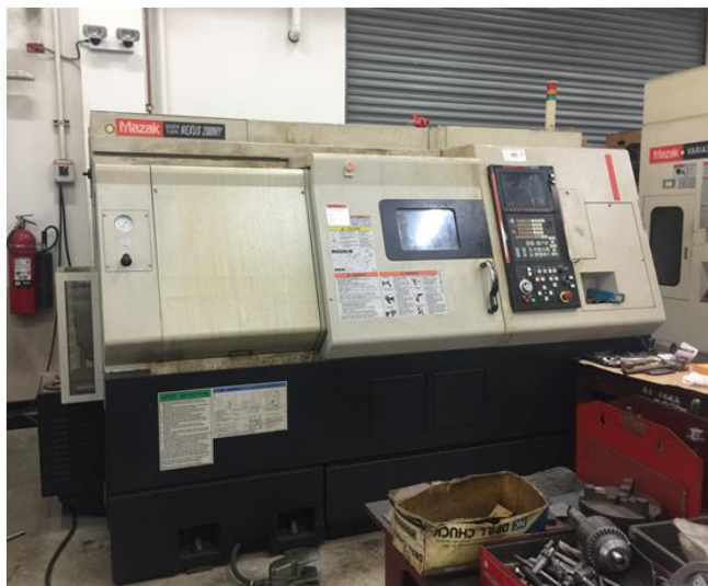
รูปที่ 3.2 เครื่องกลึงซีเอ็นซีชนิด 4 แกนยี่ห้อม Mazak รุ่น Nexus 200MY/MSY
