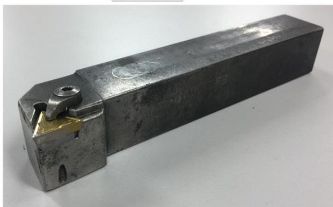
รูปที่ 3.3 ด้ามมีดกลึงยี่ห้อ Kyocera รหัสด้ามมีด CTGPR 2525M-16N มุมคายเศษโลหะ 11 องศา
