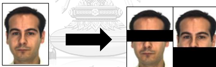
รูปที่ 3.3 ตัวอย่างการเพิ่มการบังบังใบหน้าเพื่อช่วยในการฝึกสอน
