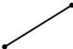
รูปที่ 2.13 ภาพแสดงเอลิเมนต์ใน 1 มิติ ได้แก่ Rod Element , Beam Element , Bar Element[18]
