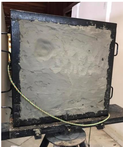
รูปที่ 3.43 ภาพแสดงอุปกรณ์ยึดจับชิ้นงานและกระบะดิน
