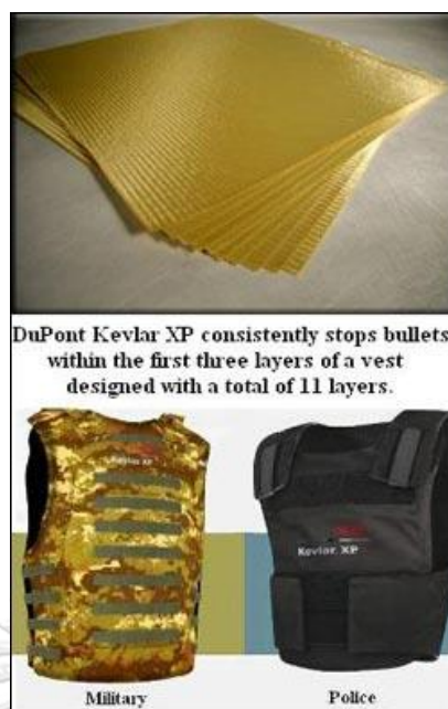
รูปที่ 2.4 วัสดุ Kevlar ที่นำมาทำเสื้อเกราะกันกระสุน [9]
