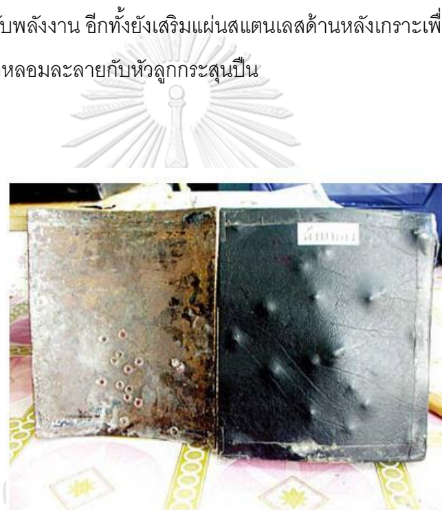
รูปที่ 2.36 ภาพแสดงชิ้นงานเสื้อเกราะพระเจ้าตากที่ใช้วัสดุฟิล์มเอ็กซ์เรย์ในทางการแพทย์ มาทดสอบ[42]
