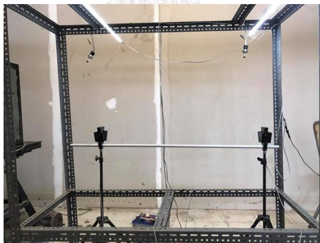
รูปที่ 3.42 ภาพแสดงเครื่องวัดความเร็วกระสุน
