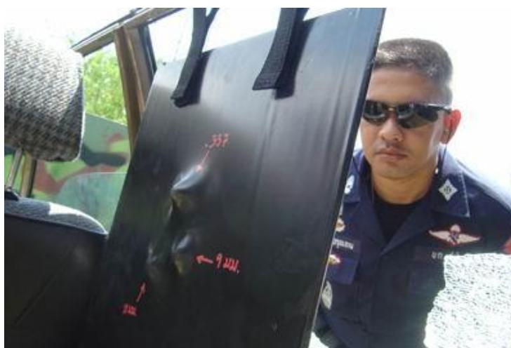
รูปที่ 2.37 ภาพแสดงชิ้นงานเสื้อเกราะบางระจันหลังจากการทดสอบยิง [44]
