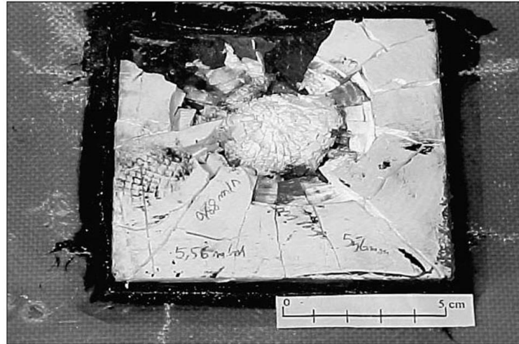
รูปที่ 2.32 ภาพแสดงรอยแตกบนชิ้นงานหลังจากยิงทดสอบซึ่งมีลักษณะแผ่ขยายเป็นรูปทรงกรวย [38]
