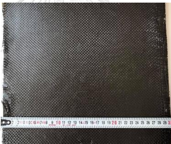
รูปที่ 4.49 แผ่นวัสดุเส้นใยคาร์บอนขนาด 30.5 cm X 30.5 cm
