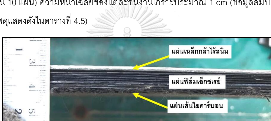
รูปที่ 4.56 แสดงภาพด้านข้างของชิ้นงานเกราะที่ผลิตจาก แผ่นเหล็กกล้าไร้สนิม จำนวน 1 แผ่น แผ่นฟิล์มเอ็กซีเรย์จำนวน 30 แผ่น และแผ่นเส้นใยคาร์บอนจำนวน 10 แผ่น ตามลำดับ
