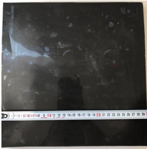
รูปที่ 4.51 แผ่นฟิล์มอินเดียม 30.5 cm x 30.5 cm
