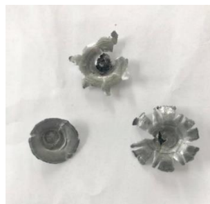
รูปที่ 4.65 แสดงความเสียหายของกระสุนหลังจากการทดสอบยิง
