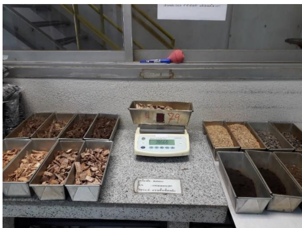
รูปที่ จ2 การวัดน้ำหนักเชื้อเพลิงชีวมวลเพื่อวิเคราะห์ความชื้น
