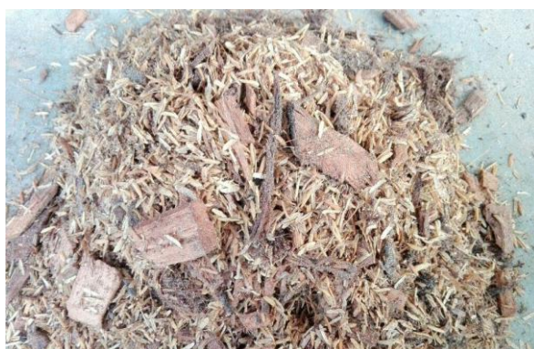
รูปที่ จ1 ตัวอย่างเชื้อเพลิงผสมที่เก็บวัดความชื้นก่อนนำเข้าผลิต
