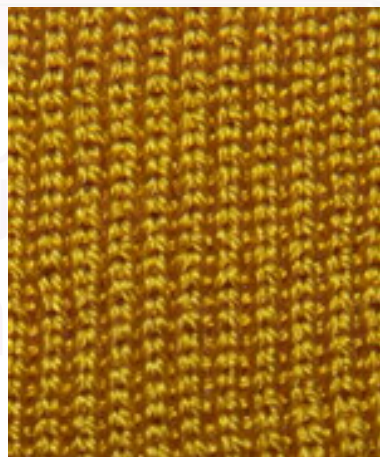
รูปที่ 4.19 ผ้าไหมย้อมที่ 100°C เวลา 40 นาที L: R = 50:1 และ ไม่ปรับ pH เติมสารช่วยย้อม สารส้ม 1.0 %owf
