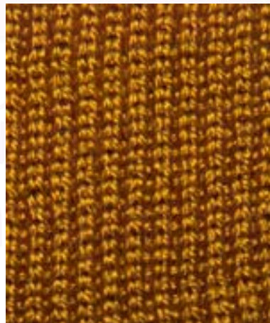
รูปที่ 4.23 ผ้าไหมย้อมที่ 100°C เวลา 40 นาที L: R= 50:1 และ ไม่ปรับ pH เติมสารช่วยสีติดทองแดง 0.1 %owf
