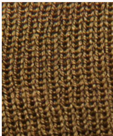
รูปที่ 4.21 ผ้าไหมย้อมที่ 100°C เวลา 40 นาที L: R= 50:1 และ ไม่ปรับ pH เติมสารช่วยสีติดเหล็ก 0.1 %owf
