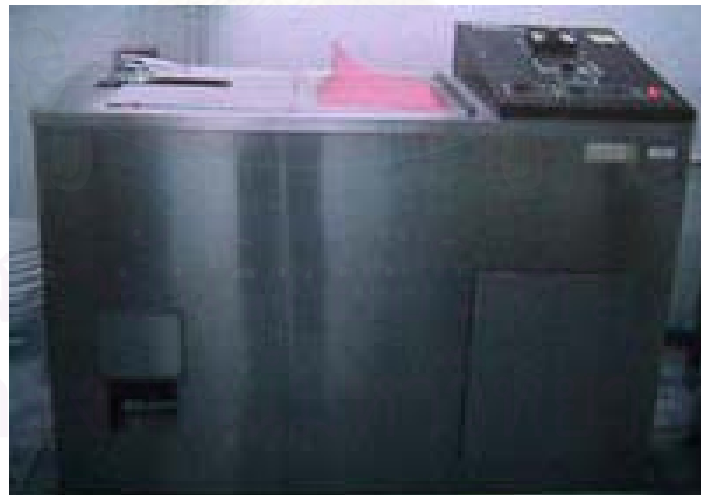
รูปที่ 3.10 เครื่องทดสอบการซักล้าง (Launder-Ometer)
