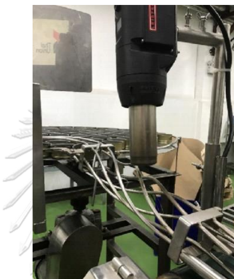
รูปที่ 34.6 ตำแหน่งเครื่องเป่าลมร้อน (ก่อนปรับปรุง)
