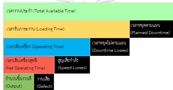
รูปที่ 28.9 รายละเอียดในการคำนวณค่าประสิทธิผลโดยรวมของเครื่องจักร
