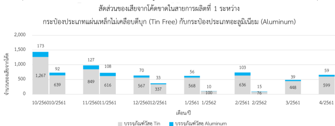
รูปที่ ก3 สัดส่วนของเสียจากโค้ดในสายการผลิตที่ 1 ระหว่างกระจกประเภทแผ่นเหล็กไม่เคลือบดีบุก (Tin Free) กับกระจกประเภทอะลูมิเนียม (Aluminum) (ก่อนและหลังการปรับปรุง)
