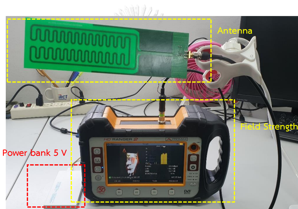
รูปที่ 3.31 การวัดทดสอบการรับสัญญาณของสายอากาศต้นแบบในสภาพแวดล้อมจริงโดย Field Strength Meter
