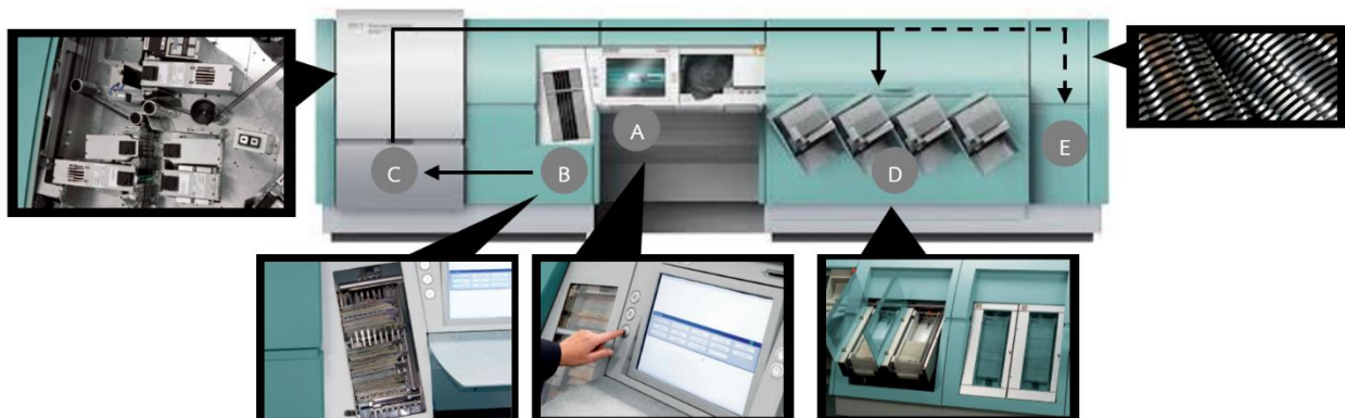
รูปที่ 19 ส่วนประกอบและขั้นตอนการทำงานของเครื่องนับคัตธันแบตเตอรี่ BPS M7
