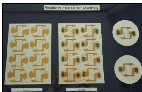
รูปที่ 5 แผ่นวงจรอิเล็กทรอนิกส์แบบยืดหยุ่นที่ผ่านกระบวนการ Punching และกระบวนการ Assembly
