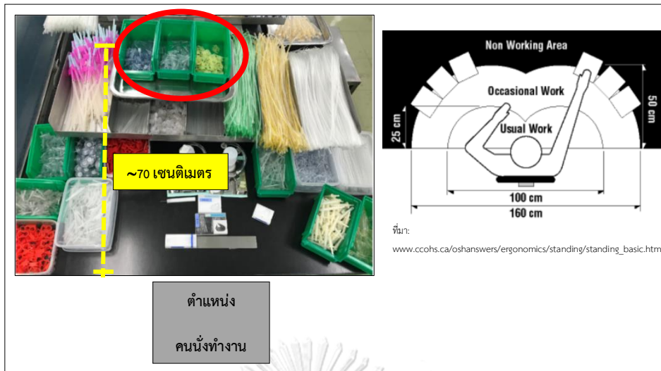
ภาพที่ 3.18 ตำแหน่งของชิ้นงานที่ต้องเอื้อมหยิบของการประกอบเซลล์แบบ 2 คนของคนที 1
