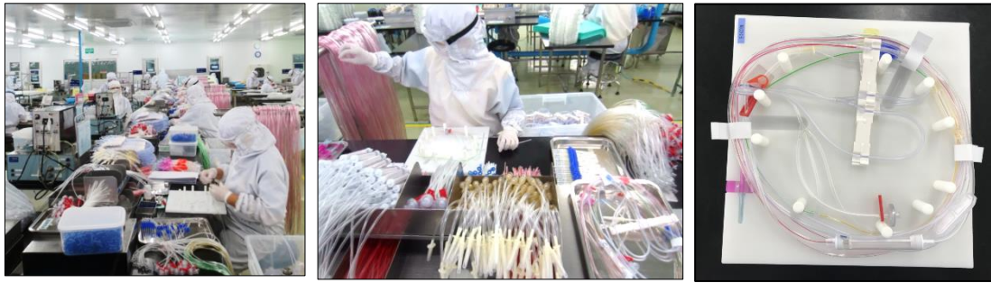
ภาพที่ 3.10 กระบวนการประกอบหลัก ที่มีการ Coiling และติดเทปกาว
