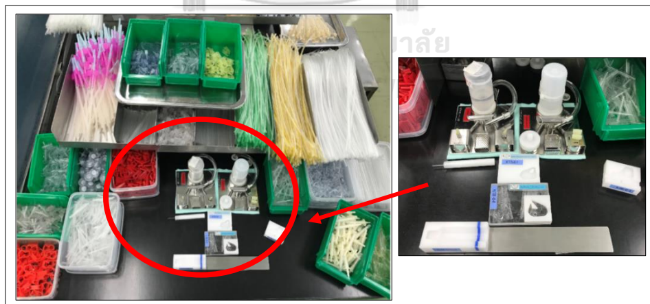
ภาพที่ 3.19 ตำแหน่งการวาง Jig และถ้วยน้ำยาของการประกอบเซลล์แบบ 2 คนของคนที 1
