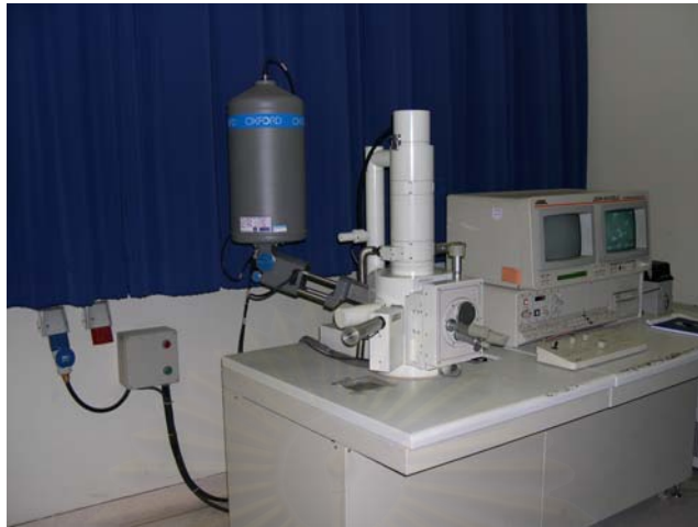
รูปที่ 9 แสดงเครื่อง SEM
