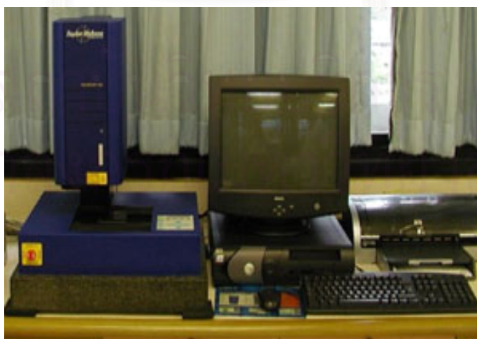
รูปที่ 5 แสดงเครื่องโปรไฟล์มิเตอร์
