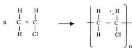
รูปที่ 2.1 ปฏิกิริยาการเกิดพอลิไวนิลคลอไรด์
