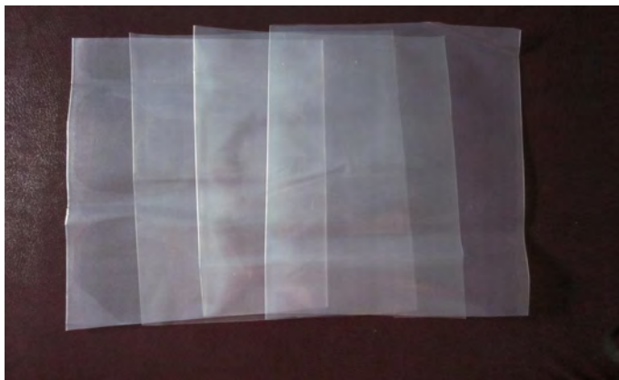
รูปที่ 4.7 फिल्मพอลิเอทิลีนผสมระหว่างพอลิเอทิลีนชนิดความหนาแน่นต่ำกับพอลิเอทิลีนชนิดความหนาแน่นสูงที่อัตราส่วนผสมต่างๆ
