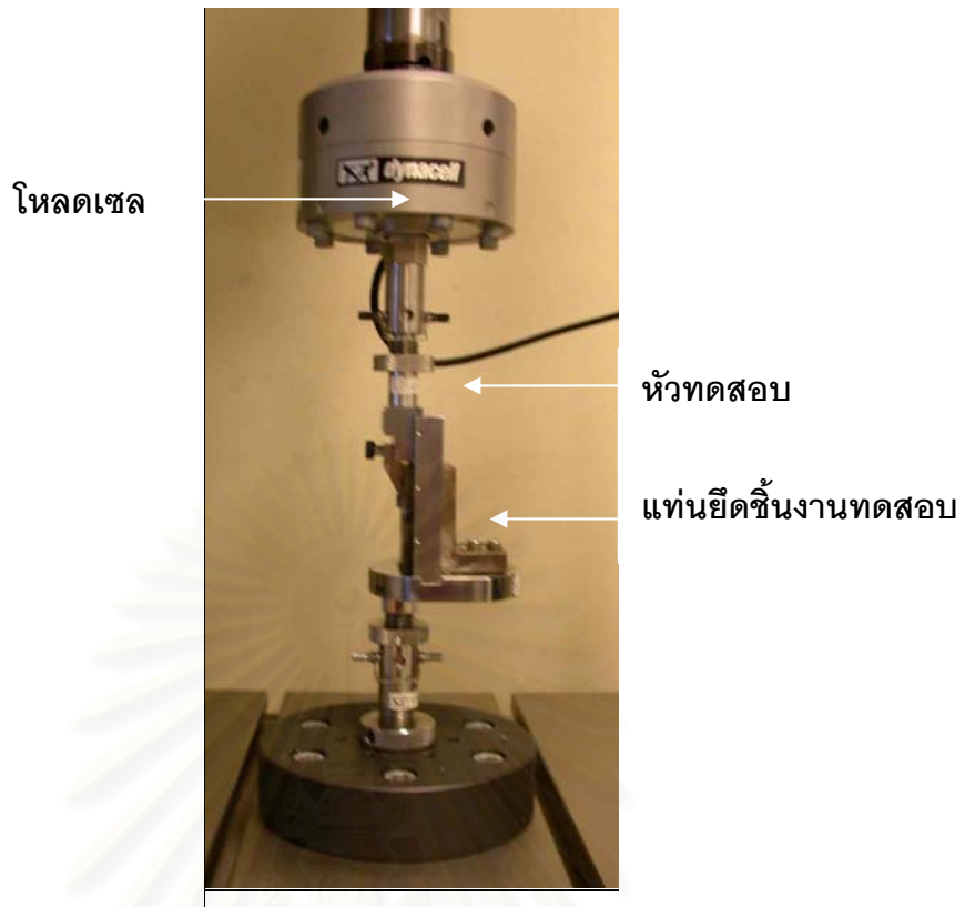
รูปที่ 14 แสดงส่วนประกอบของเครื่องทดสอบสากลชนิดอินสตรอน
