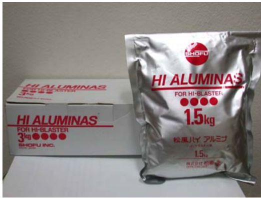
ก. เป่าด้วยผงอะลูมิเนียมออกไซด์ 50 ไมครอน
