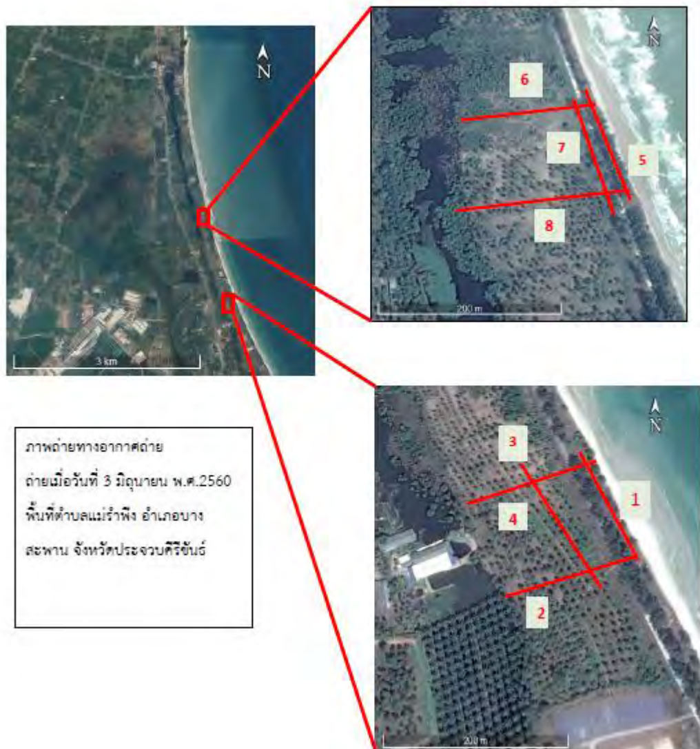
รูปที่ 3.8(บนซ้าย),3.9(บนขวา),3.10(ล่างขวา) แสดงการวางแผนการลากเครื่อง GPR บริเวณหาดแม่รำพึง อำเภอบางสะพานจังหวัดประจวบคีรีขันธ์
