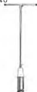
รูปที่ 3.27 แสดงอุปกรณ์การเจาะโดยใช้สว่านแบบมือ(Hand Auger)
