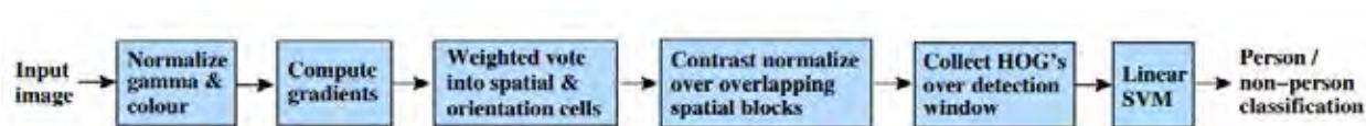
ภาพที่ 2.6 ภาพรวมวิธีการสกัดหาคุณลักษณะเฉพาะในการตรวจจับวัตถุ
