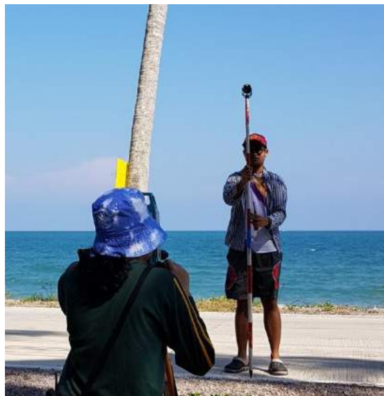
รูปที่ 3.3.4 กล้องสำรวจวัดระดับ (ซ้าย) และไม้ Pole ที่ติดตั้งปริซึม (ขวา)
