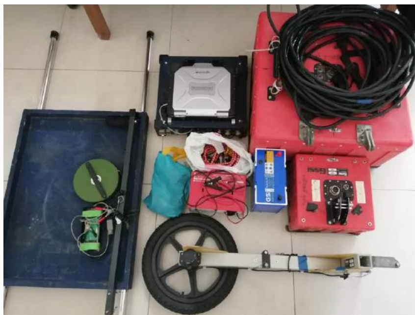
รูปที่ 3.5.4 เครื่องมือและอุปกรณ์ที่ใช้ในการสำรวจด้วยการธรณีฟิสิกส์ด้วยเรดาร์
