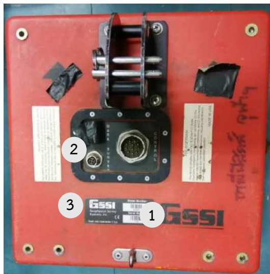
รูปที่ 3.5.3 ตำแหน่งจุดเชื่อมต่อบนกล่องสายอากาศ
