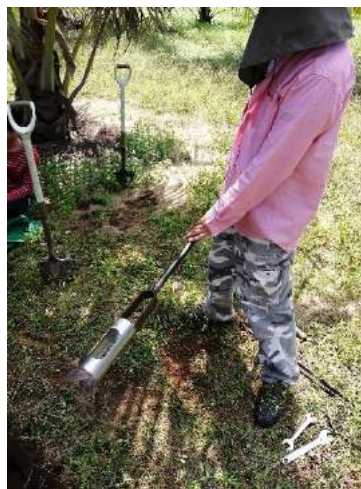
รูปที่ 3.3.2 ลักษณะหลุม (ซ้าย) และเครื่องเจาะแบบมือหมุน หัวเจาะ Mud auger (กลาง) Gouge auger (ขวา)
