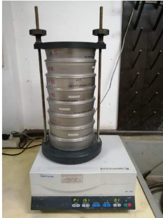
รูปที่ 3.4.3 เครื่องคัดขนาด (sieve shaker) ที่ประกอบด้วยตะแกรงคัดขนาด (sieve mesh) เบอร์ต่างๆ
