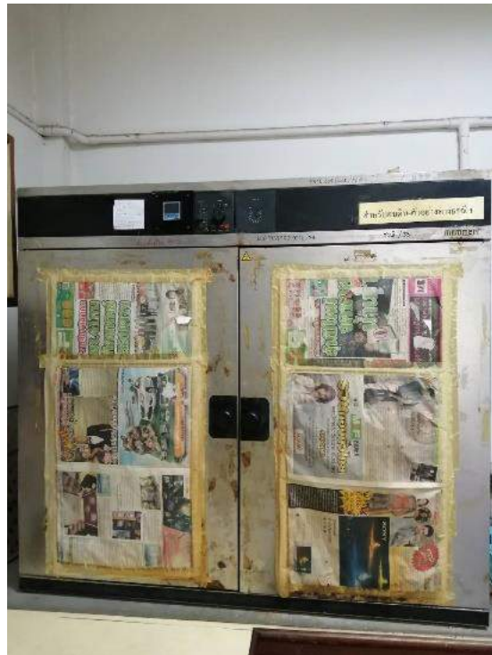
รูปที่ 3.4.2 ตู้อบตะกอนที่ตั้งอุณหภูมิ 70 องศาเซลเซียส
