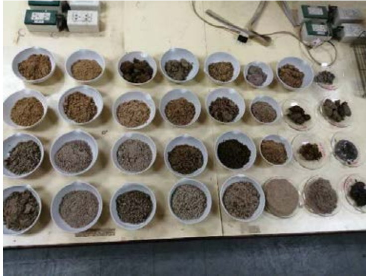
รูปที่ 3.4.1 ตัวอย่างตะกอนที่นำมาใส่ในชามเพื่อเตรียมอบ
