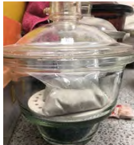
รูปที่ 3.4 ภาพภาชนะที่มีซิลิกาเจลอยู่ภายใน
