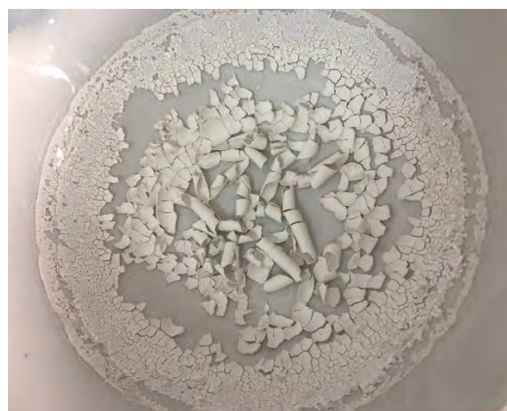
รูปที่ 3.6 ภาพมอนต์มอริลโลไนต์ที่อบแห้ง หลังจากทำการปรับสภาพ
