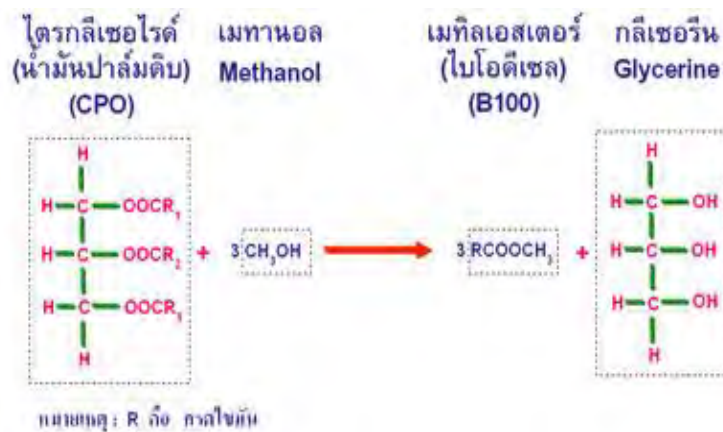
รูปที่ 1.1 ปฏิกิริยา Transesterification ในกระบวนการผลิตไบโอดีเซล [1]
